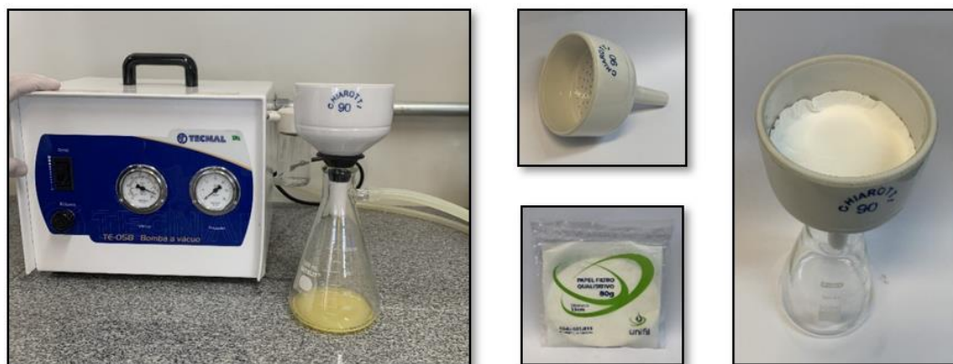
Figura 18 – Processo de filtragem do óleo de Moringa Oleífera Aparato experimental Funil e Filtro
