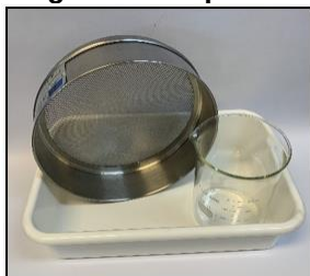
Figura 17 – Aparatos utilizados no peneiramento
