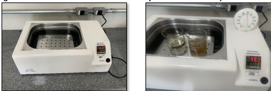
Figura 19 – Processo de banho maria ao qual o óleo de babaçu foi submetido
