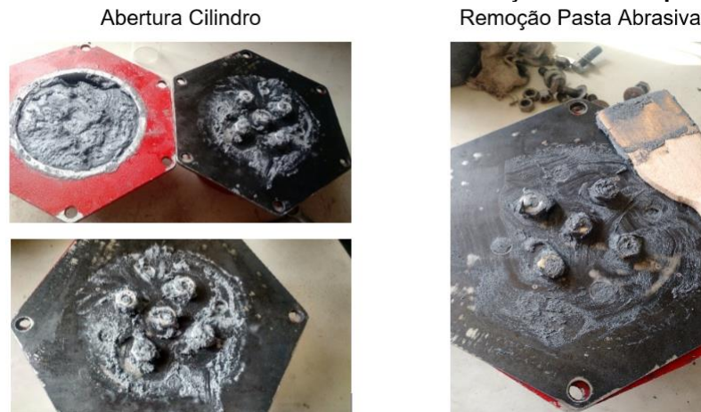
Figura 27 – Abertura Cilindro com as Amostras e remoção inicial da pasta abrasiva
