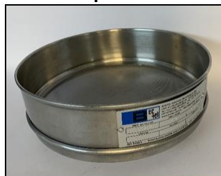
Figura 17 – Aparatos utilizados no peneiramento
