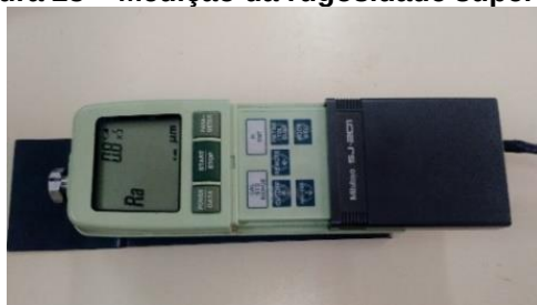
Figura 23 – Medição da rugosidade superficial
