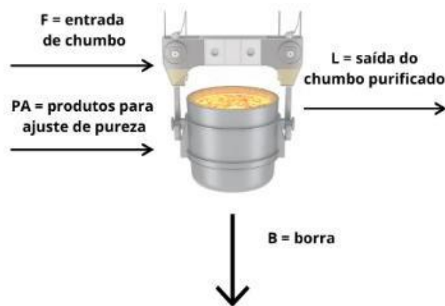
Figura 13 – Fluxograma da panela de refino de chumbo duro e mole
