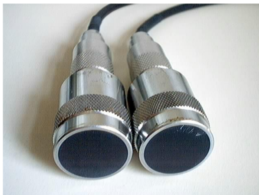
Figura 11 - Transdutores utilizados no sistema de varredura.
