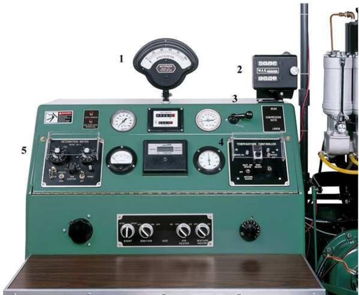
Figura 1-13: Vista geral do painel de instrumentos do motor CFR
