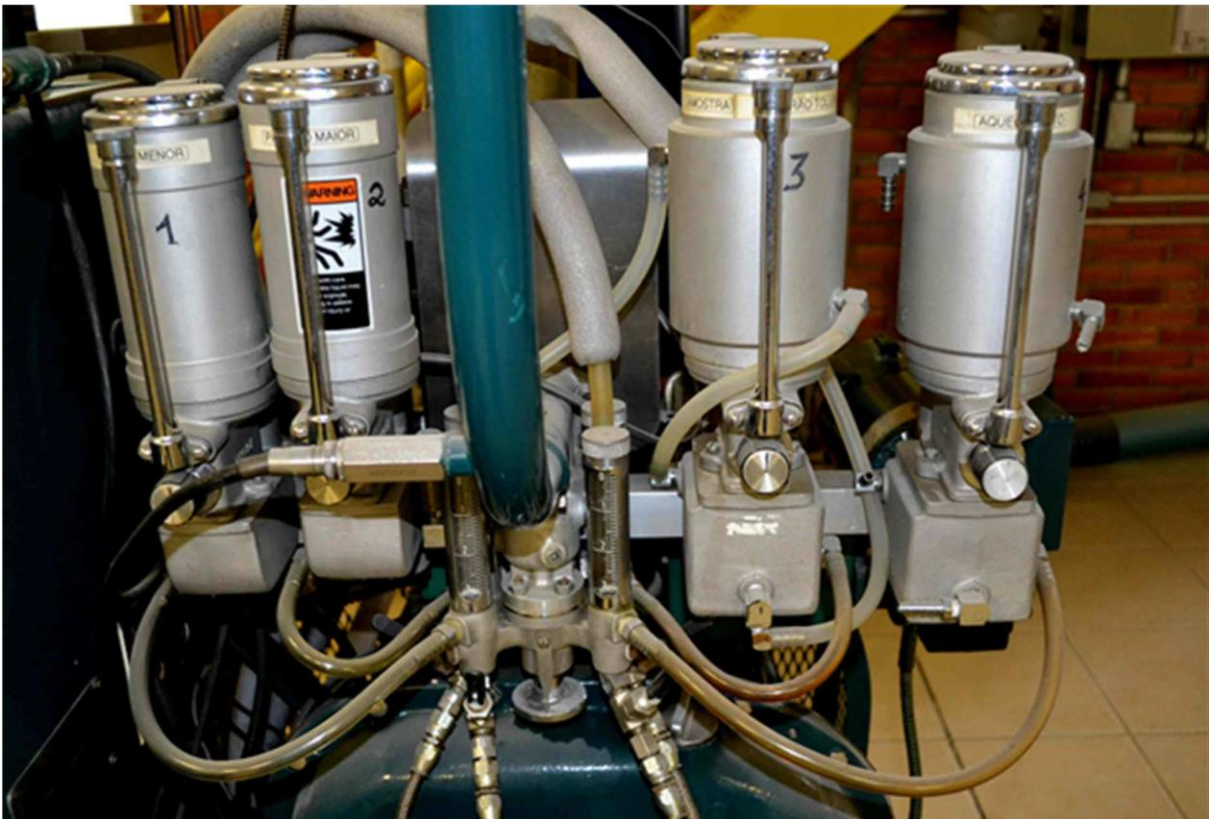
Figura 4-4: Carburadores, válvula seletora e válvulas de dreno do motor CFR
