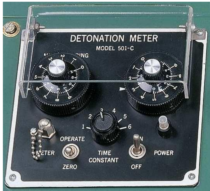
Figura 4-10: Vista do painel frontal do amplificador mostrando seus botões de ajuste
