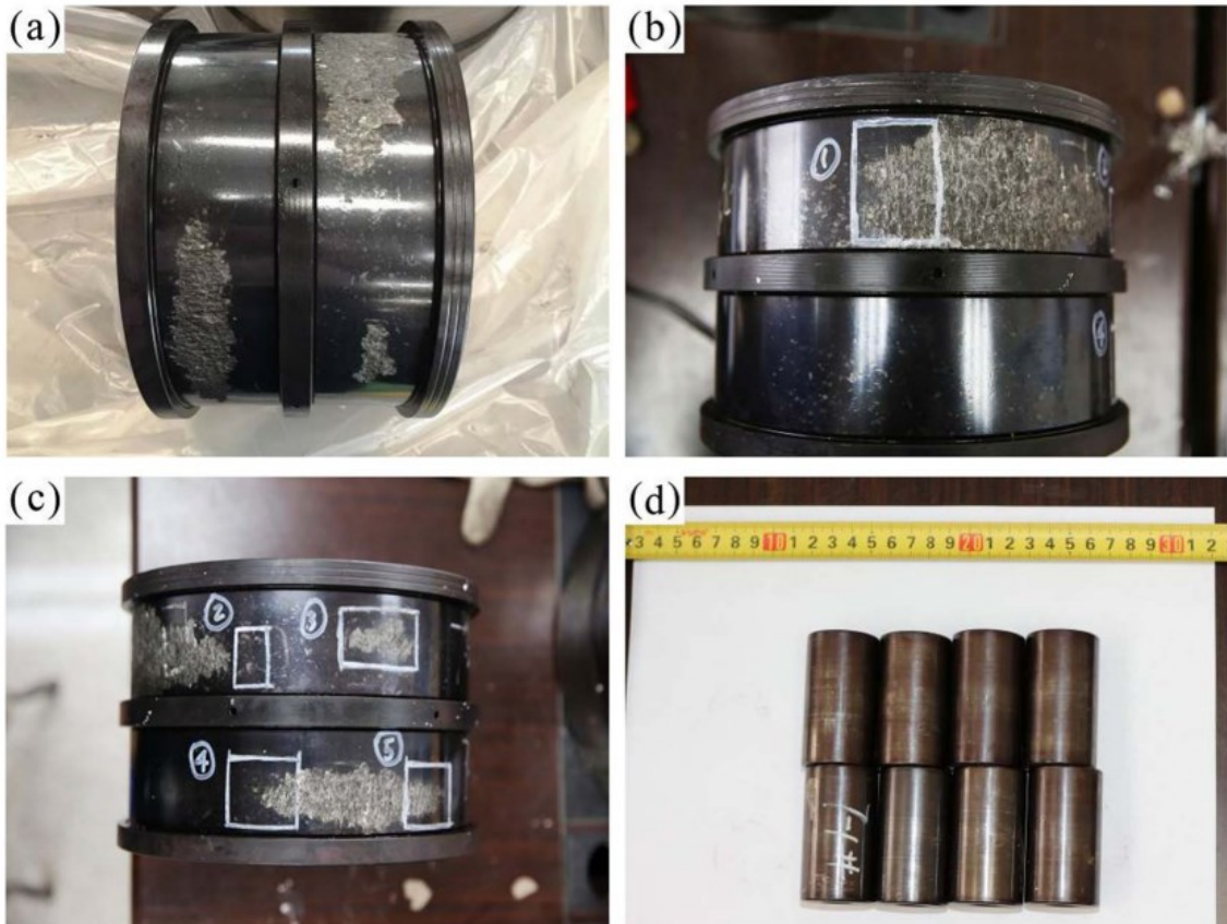
Figura 26 - Aparências externas do rolamento de rolos com falha fornecido no local. (a) três áreas de desgaste na pista do anel interno (b) amostra da área 1 (c) amostra das áreas 2 a 5 (d) oito rolos cilíndricos
