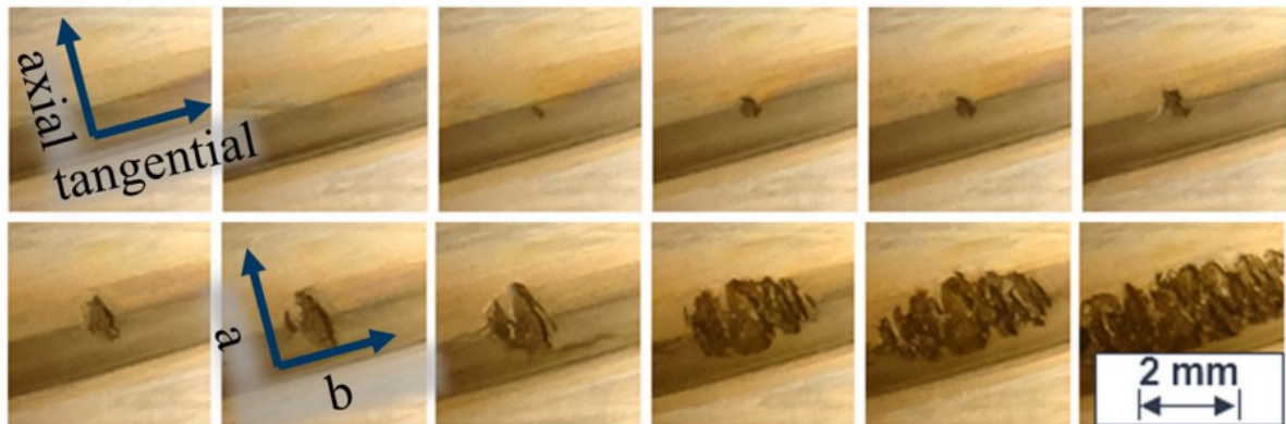
Figura 21 - Progresso do desgaste por pite em duas amostras
