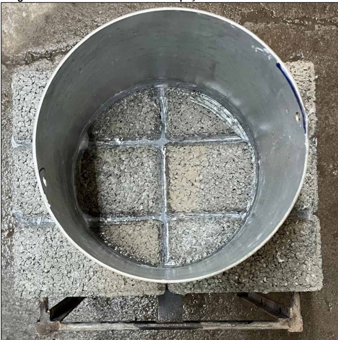
Imagem 4 – Pavers com silicone nos espaçamentos.
