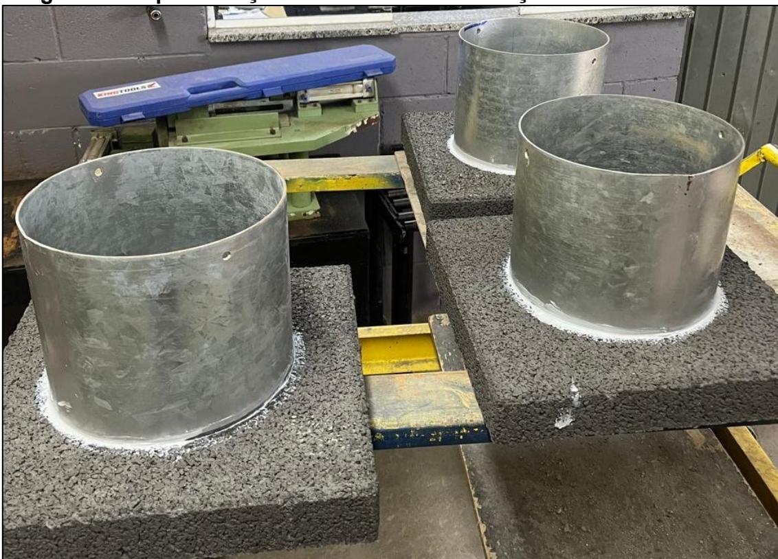
Imagem 3 – Representação dos cilindros de medição instalados.
