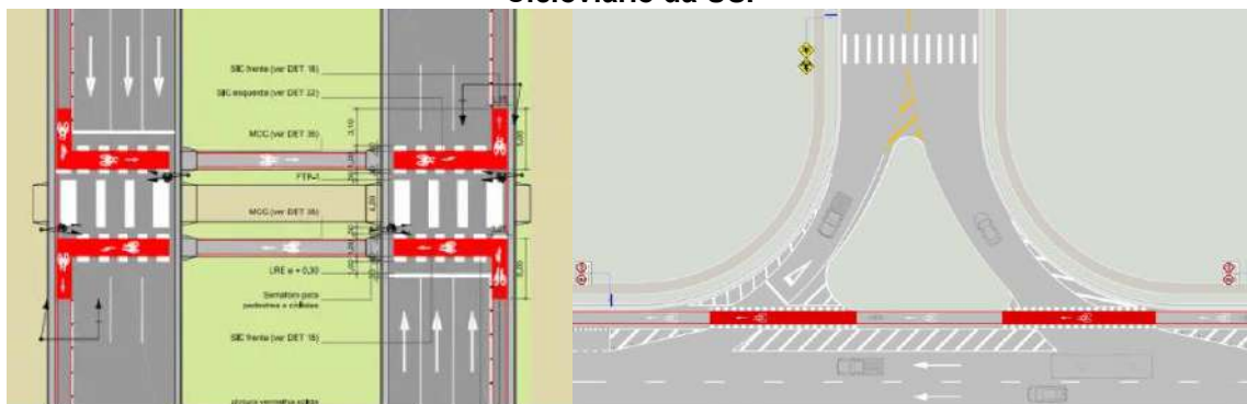
Figura 11 - Plantas de novas travessias e cruzamentos com prioridade para ciclistas do Plano Ciclovitário da USP
