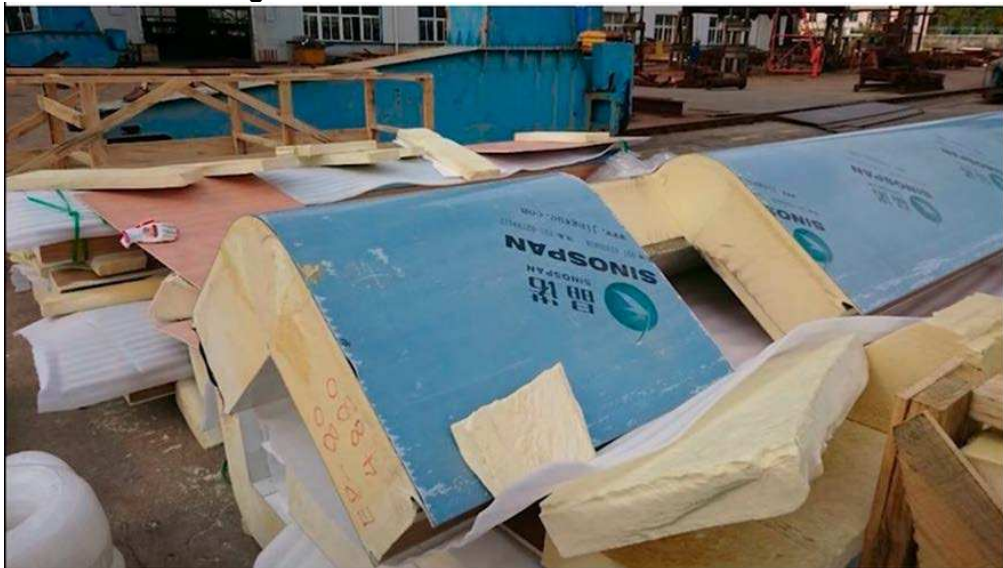
Figura 37 – Painel Metálico com Poliuretano.
