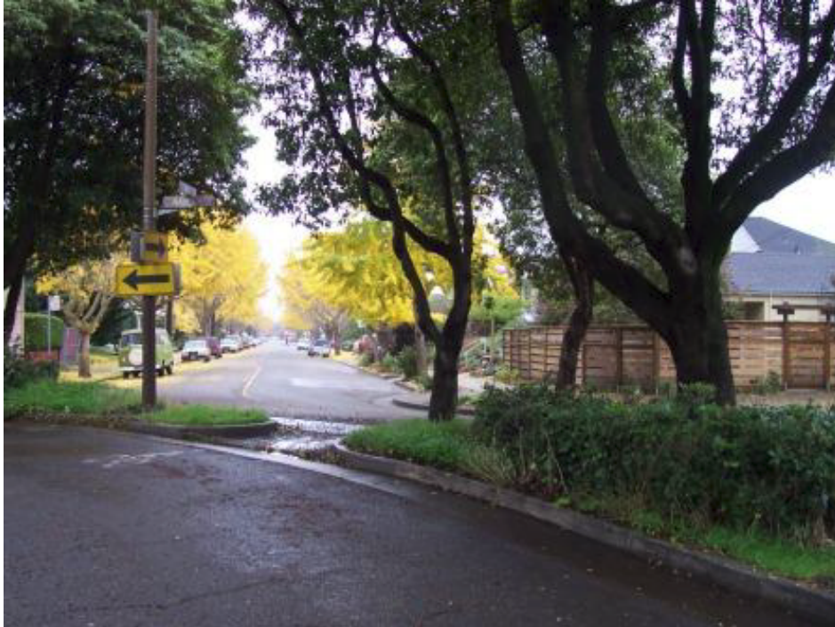
Figura 46 – Diagonal diverter acessível para bicicletas em cidade nos EUA Fonte: Internet [s.n.t.]
