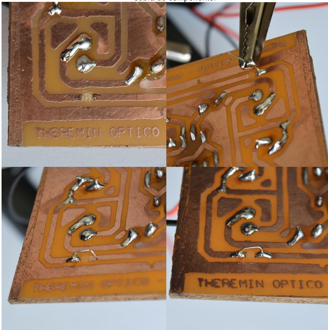
Figuras 54A, 54B, 54C e 54D – Fotos de uma falha na trilha e de um jumper feito com uma sobra de componente.
