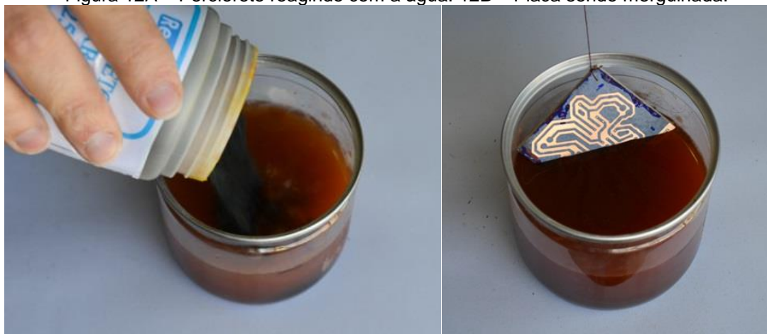
Figura 12A – Percloreto reagindo com a água. 12B – Placa sendo mergulhada.
