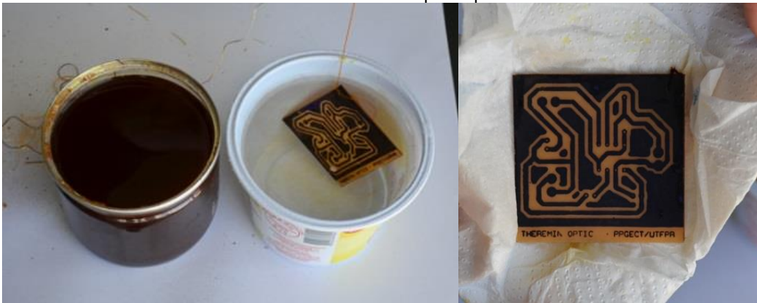
Figura 14A – Placa de fenolite sendo limpa na água. 14B – Placa de fenolite sendo seca após o processo de corrosão.
