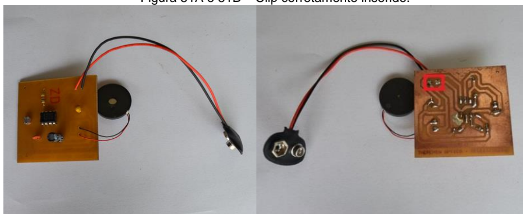
Figura 51A e 51B – Clip corretamente inserido.
