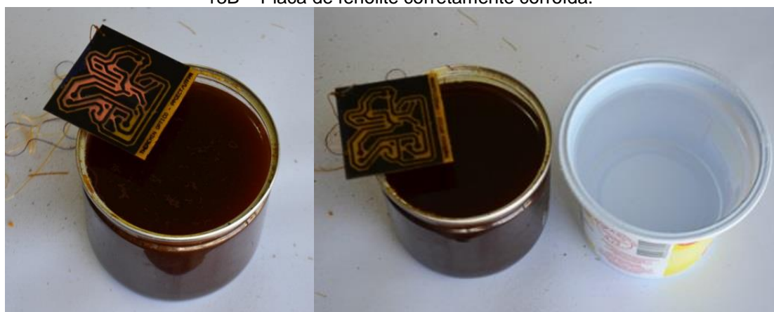
Figura 13A – Placa de fenolite parcialmente corroída. 13B – Placa de fenolite corretamente corroída.
