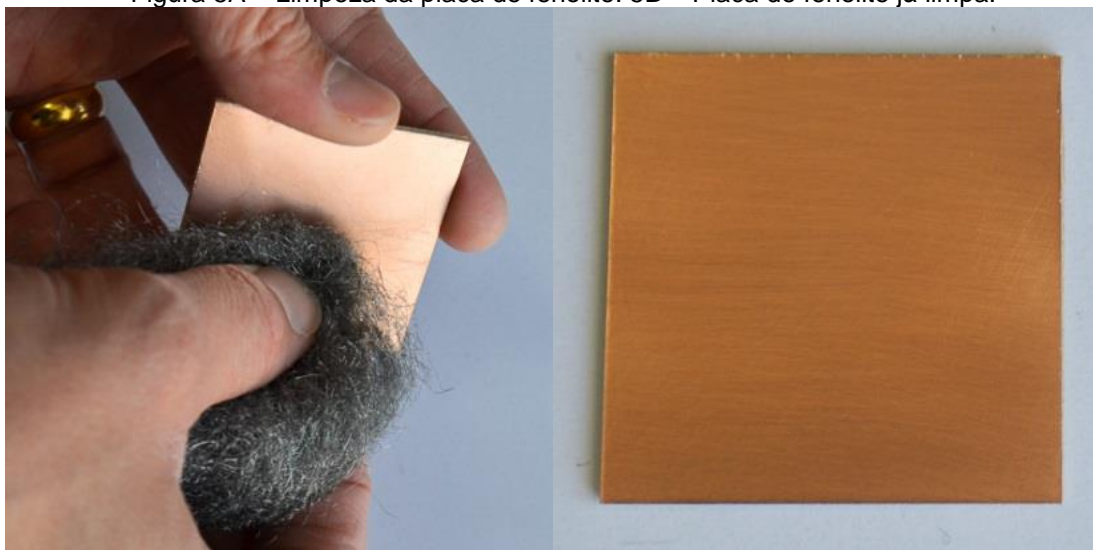
Figura 5A – Limpeza da placa de fenolite. 5B – Placa de fenolite já limpa.
