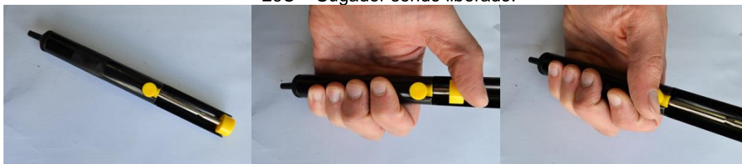
Figura 26A – Sugador de solda. 26B – Sugador de solda sendo acionado. 26C – Sugador sendo liberado.
