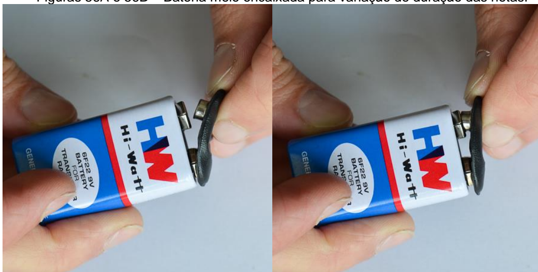
Figuras 56A e 56B – Bateria meio encaixada para variação de duração das notas.
