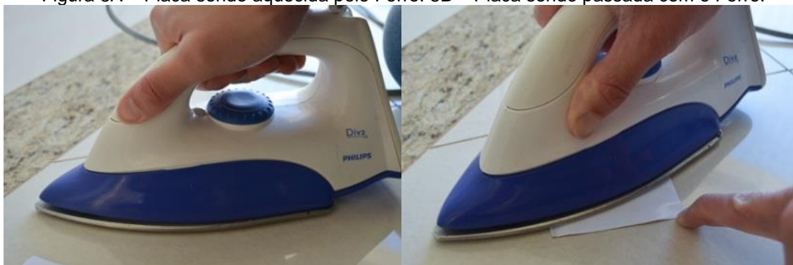
Figura 8A – Placa sendo aquecida pelo Ferro. 8B – Placa sendo passada com o Ferro.
