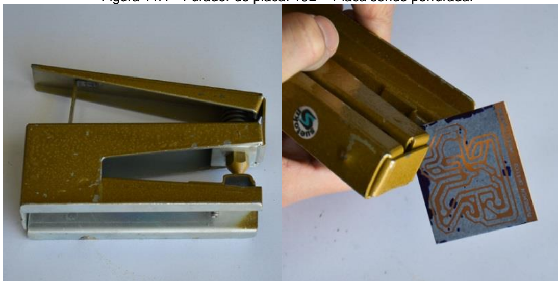
Figura 11A – Furador de placa. 10B – Placa sendo perfurada.
