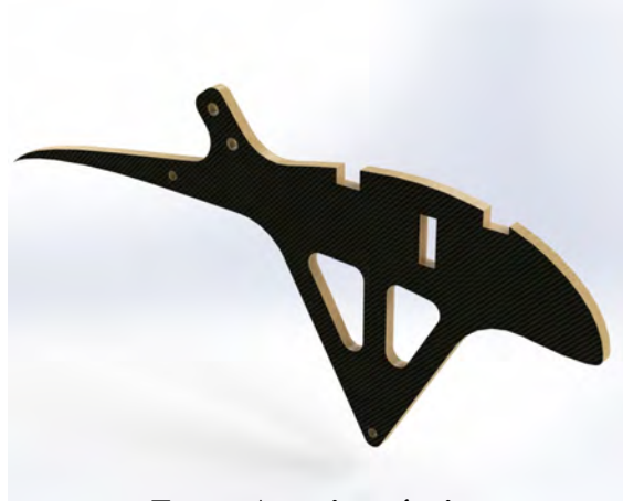
Figura 70: Nervura da asa conjugada a estrutura do Trem de pouso principal.
