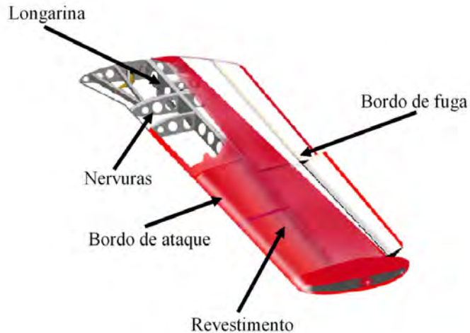
Figura 11: Estrutura típica de uma asa entelada.
