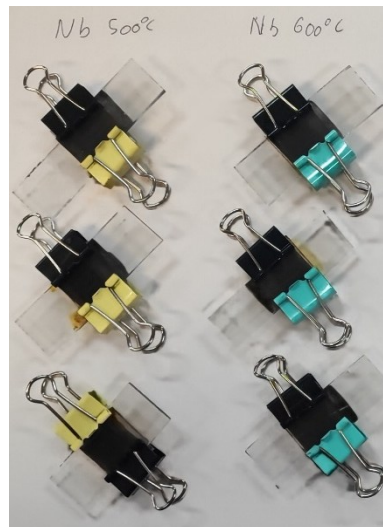
Figura 5 - CSSCs montadas em formato sanduiche
