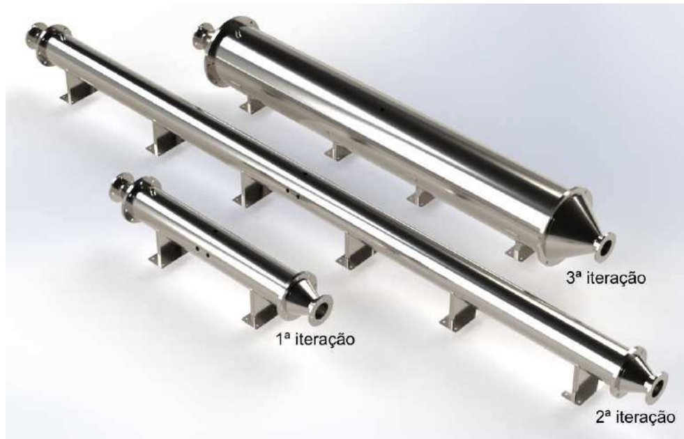
Figura 23 - Comparação geométrica entre os 3 modelos de trocadores estudados.
