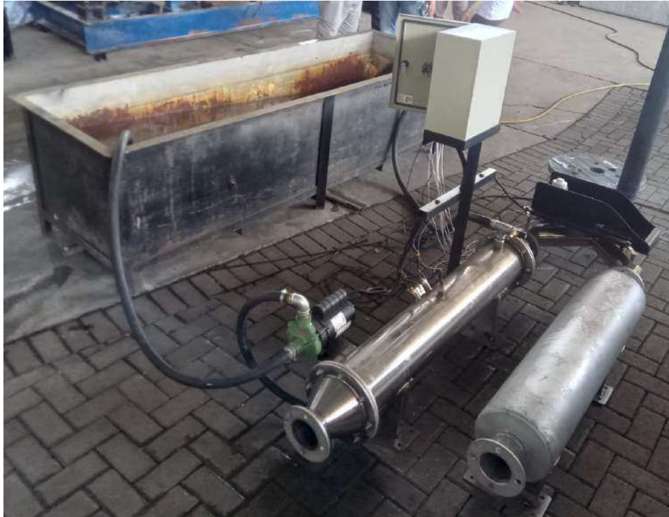
Fotografia 1 - Teste do sistema de troca térmica.
