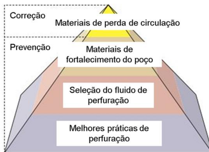
Figura 1.3 – Práticas para o controle e prevenção da perda de circulação. Adaptado de Cook et al. (2012).
