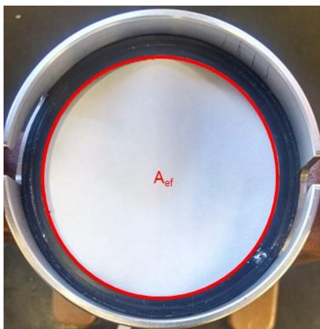
Figura 3.4 – Montagem do papel filtro (PF) na base da célula de filtração (CF), representando a área efetiva de filtração ( A_{ef} ).
