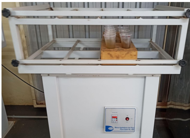
Figura 9 - Agitação das amostras em agitadora mecânica a 220 rpm.
