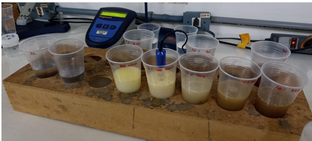
Figura 20 - Disposição das amostras para medição de pH.
