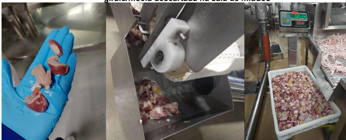
Imagem 4 – Moela despedaçada na saída da máquina/moela derrubada pela esteira girafa/moela descartada na sala de miúdos
