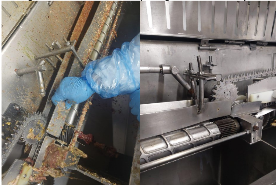
Imagem 5 – Guia sem fixador na ponta/guia com fixador na ponta
