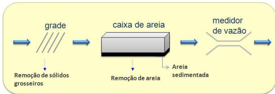
Figura 1: Esquema de tratamento preliminar Fonte: Adaptado de Von Sperling (1996).
