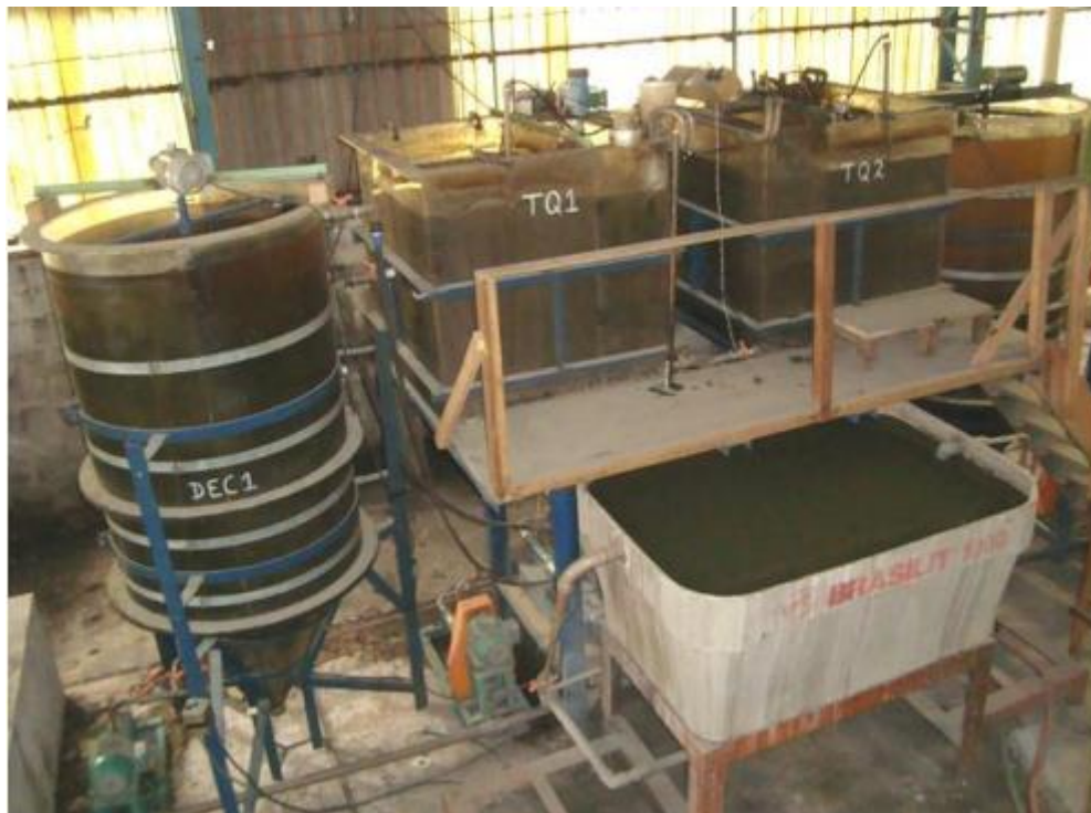
Figura 9: Sistema de lodo ativado em escala piloto Fonte: Fujii (2011).
