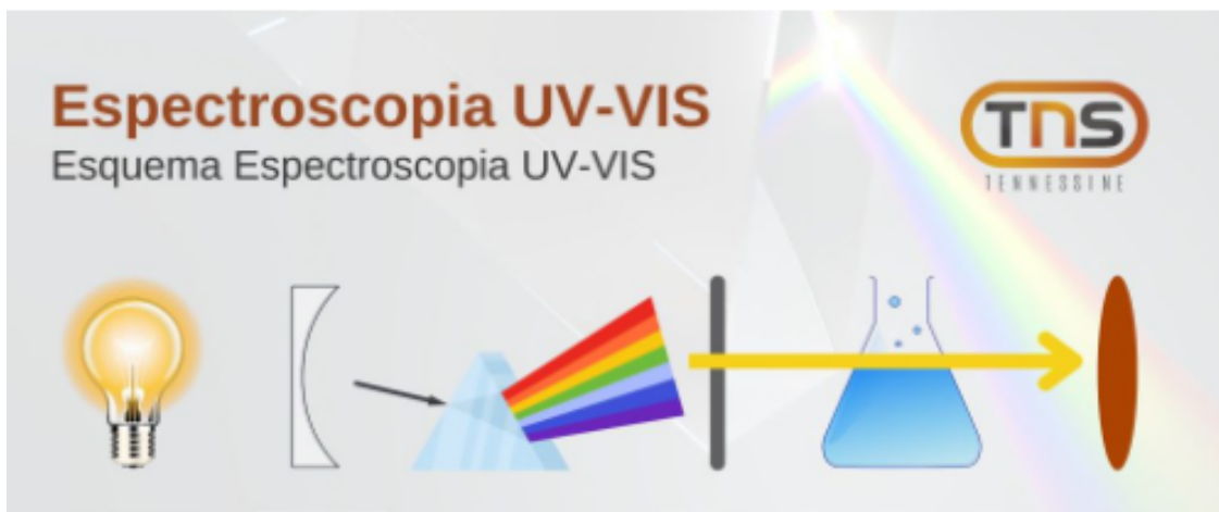
Figura 4: Esquema de funcionamento do equipamento Espectroscopia de UV VIS.
