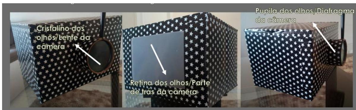
Figura 13: Fotografia da caixa construída pela equipe Duília da turma 3C.
