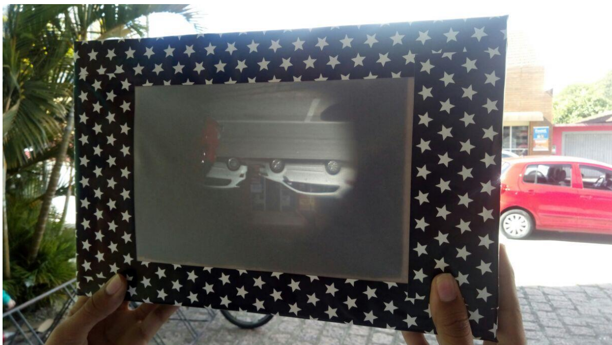
Figura 14: Fotografia da caixa que representa o olho humano sem anomalias e da imagem obtida.
