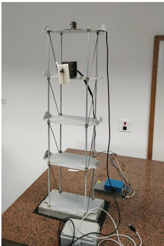
Figura 34 – Montagem para a determinação das frequências naturais com a base do ADV e com o excitador.
