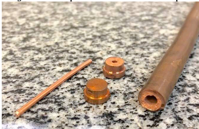
Fotografia 19 - Componentes do tubo de calor do Tipo #2
