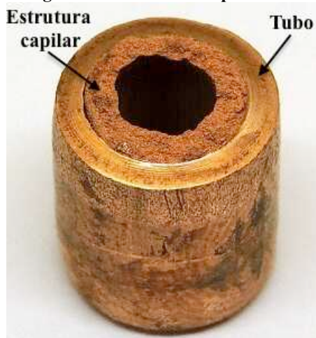
Fotografia 2 - Estrutura capilar sinterizada de pó de cobre
