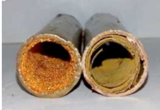
Fotografia 3 - Vista transversal dos tubos de calor após o uso de nanofluido de CuO
