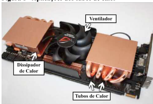
(a) Resfriamento de equipamentos eletroeletrônicos
