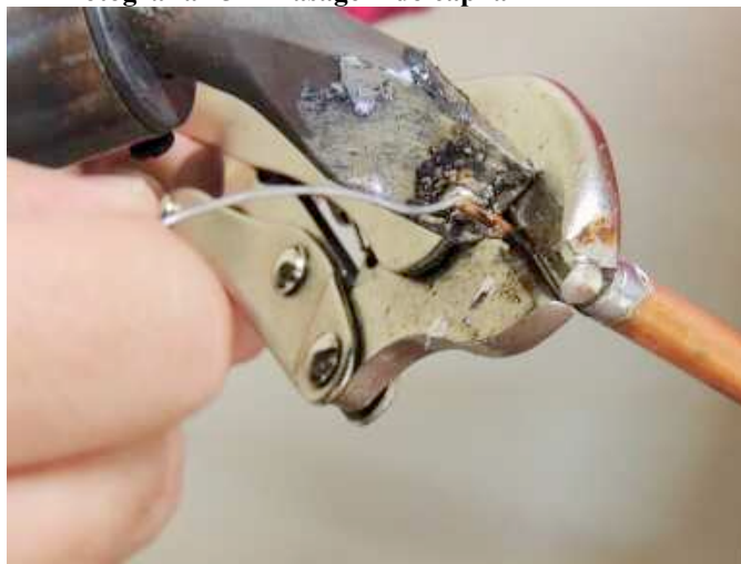
Fotografia 25 - Brasagem do capilar
