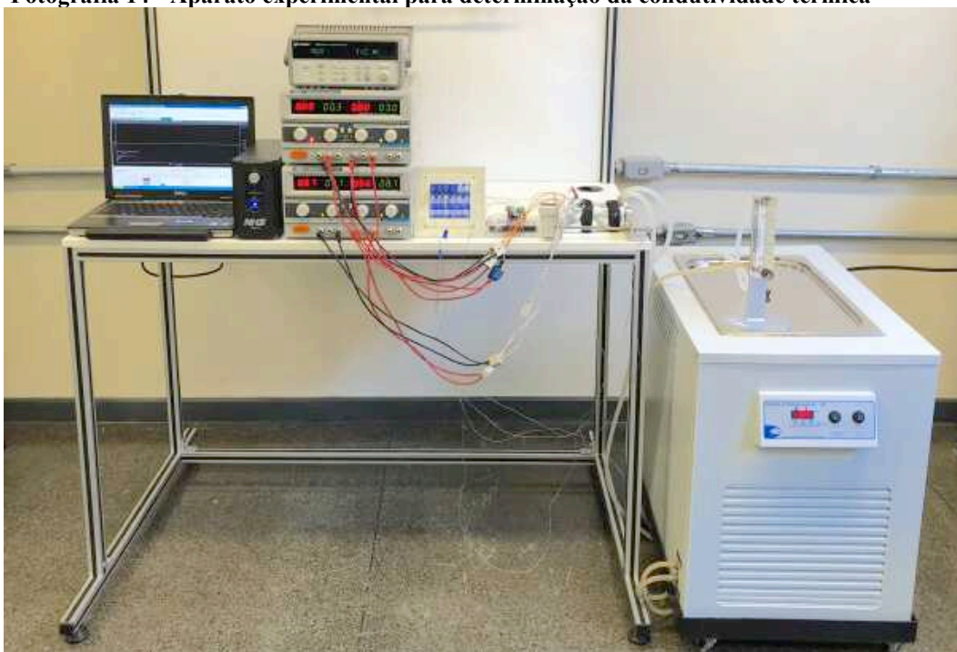
Fotografia 14 - Aparato experimental para determinação da condutividade térmica
