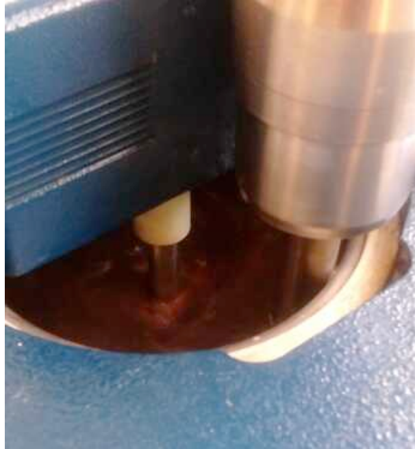
Fotografia 5 - Equipamento para ensaio de distribuição granulométrica a laser do pó de cobre
