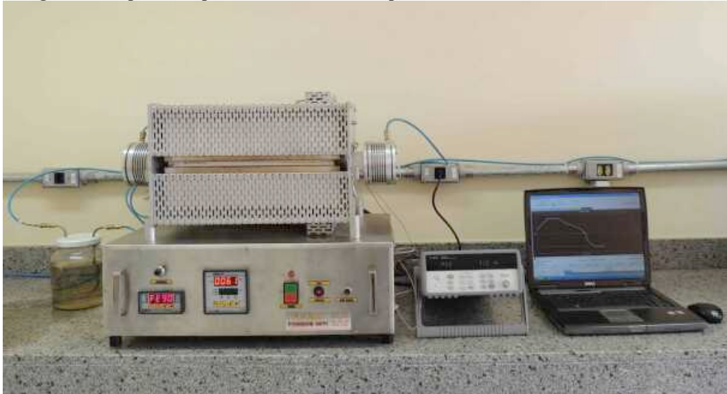
Fotografia 7 - Aparato experimental utilizado no processo de sinterização
