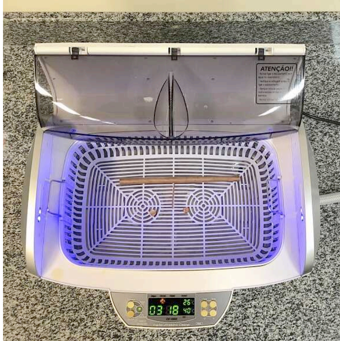
Fotografia 20 - Banho ultrassônico com componentes dos tubos de calor imersos em acetona
