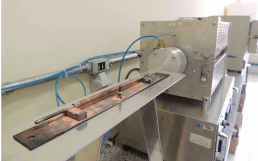
Fotografia 6 - Equipamento usado na preparação do tubo de cobre para a sinterização
