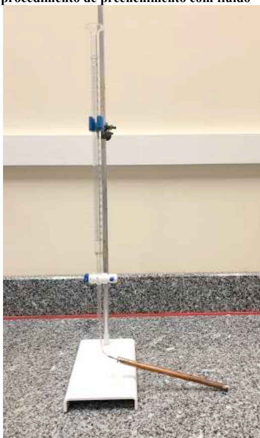
Fotografia 24 - Tubo de calor no procedimento de preenchimento com fluido
