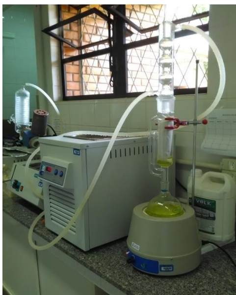
Figura 9- Extração da semente de quinoa por soxhlet Fonte: Autoria própria (2017)
