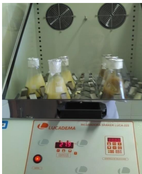
Figura 10- Extração da semente de quinoa por agitação Fonte: Autoria própria (2017)
