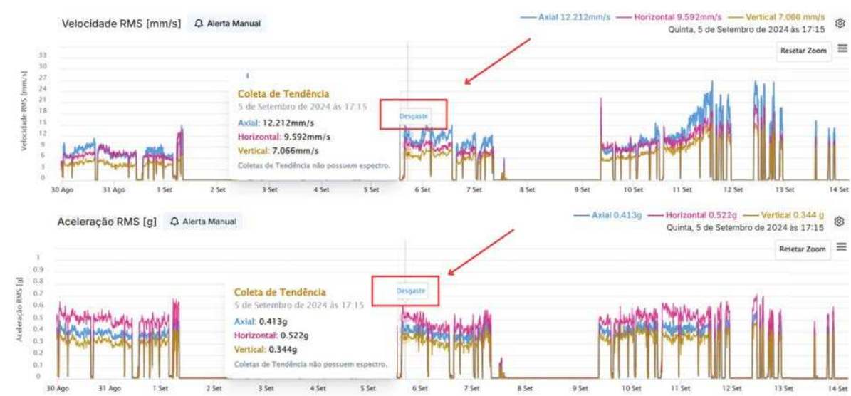
Figura 21 – Identificação de Desgaste.
