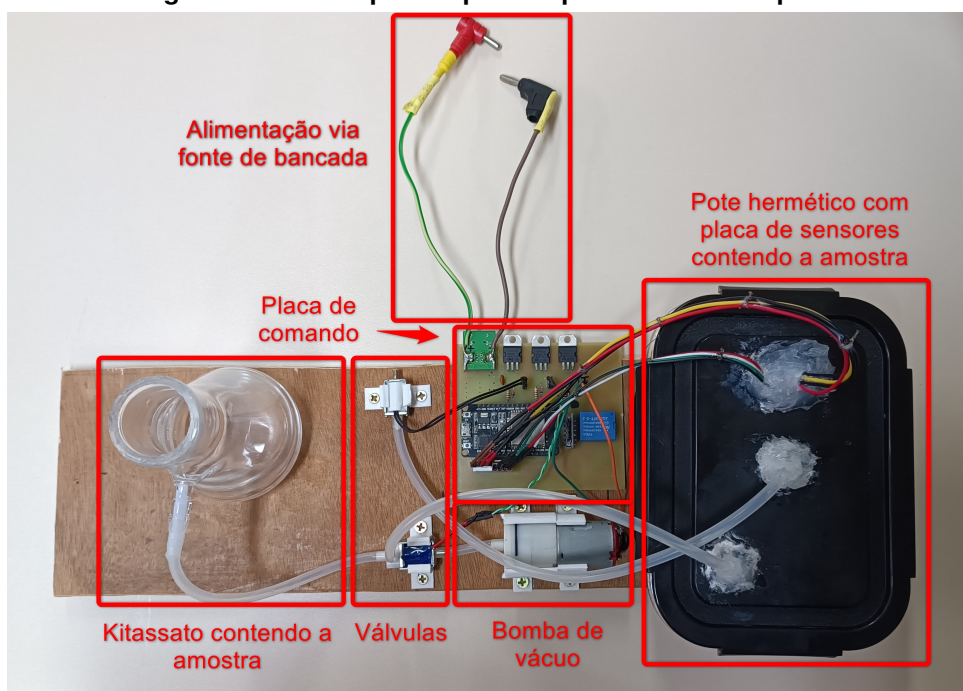
Figura 28 – Protótipo completo explicado - Vista superior
