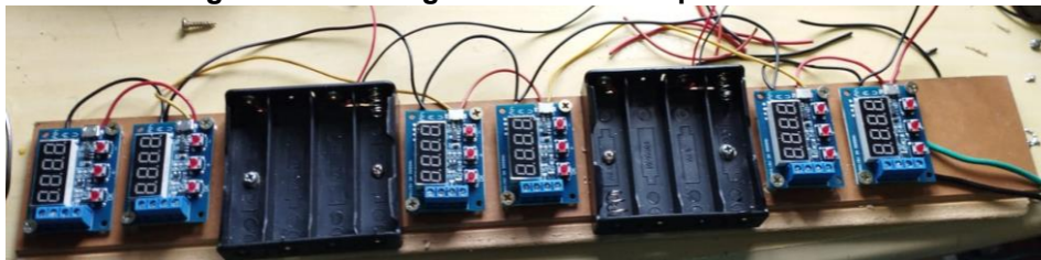
Fotografia 4 - Montagem testadores capacidade
