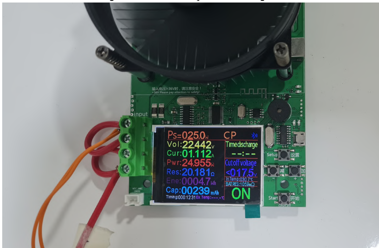
Figura 31 – Parametrização do descarregador
