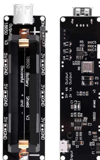
Figura 12 – MÓDULO DA BATERIA (HAREENDRAN, 2019)
