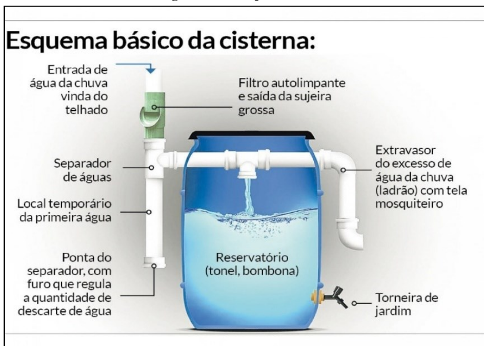
Figura 2 – Um tipo de cisterna
