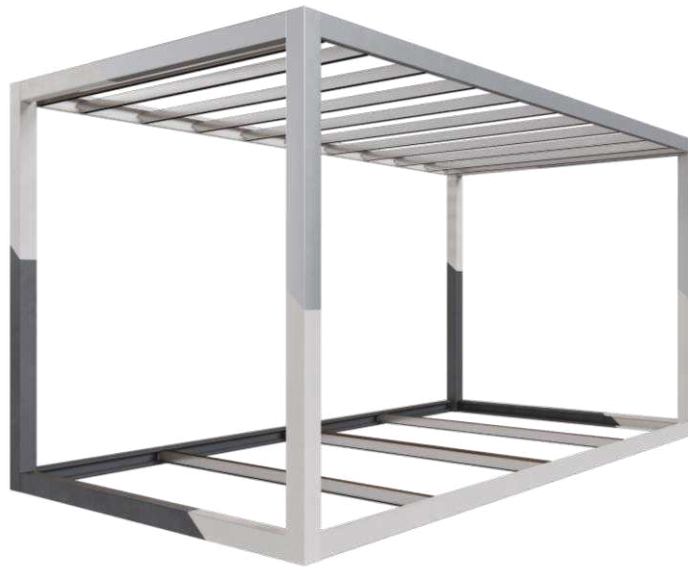
Figura 17 - Esquema da estrutura de aço galvanizado
