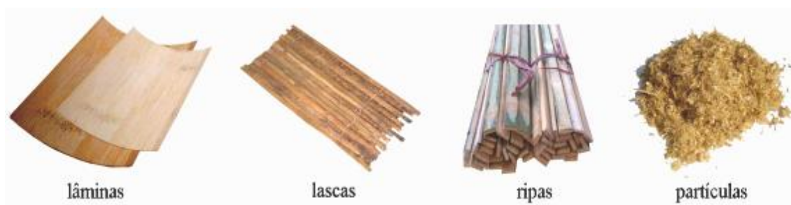
Figura 2.2 - Tipos de elementos empregados na fabricação de painéis de bambu.
