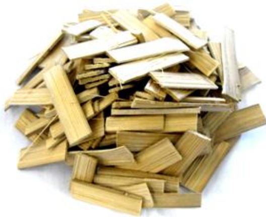
Figura 3.19 - Cavacos analisados e utilizados na produção de polpa de bambu para manufatura de amostras de MDF.
