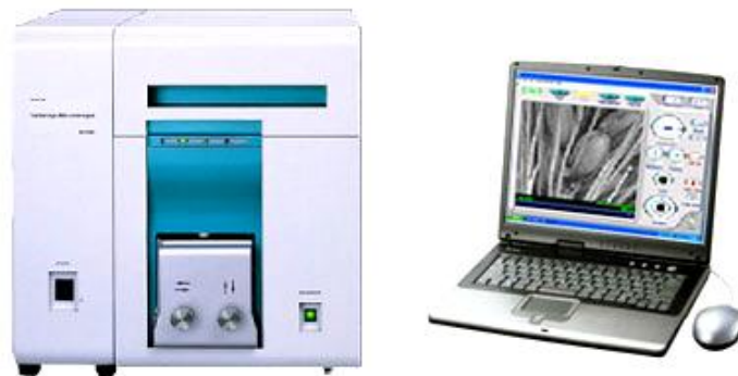
Figura 3.32 – MEV de bancada para as análises da microestrutura (Hitachi TM-1000).
