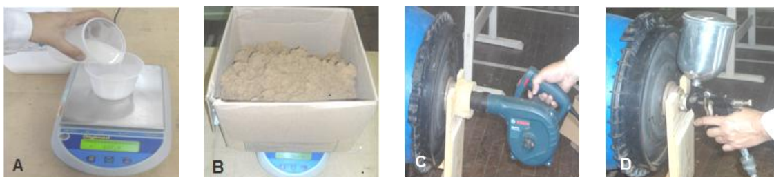
Figura 3.25 – Fluxo de atividades para encolagem das fibras: pesagem dos componentes (A); pesagem da massa de fibra (B); aplicação de jato de ar (C); pulverização dos componentes na fibra (D)
