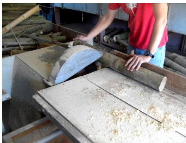
Figura 3.18 - Corte dos colmos em anéis com serra circular (destopadeira) para a produção de cavacos
