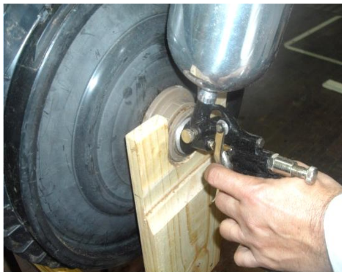
Figura 3.24 – Pulverização da emulsão de parafina em misturador rotativo
