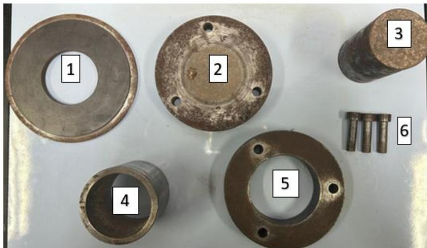
1 – Adaptador para amostras; 2- Base circular; 3- Cilindro maciço de aplicação de carga; 4- Cilindro de acomodação da amostra; 5- Anel de fixação; 6- Pinos de fixação.
