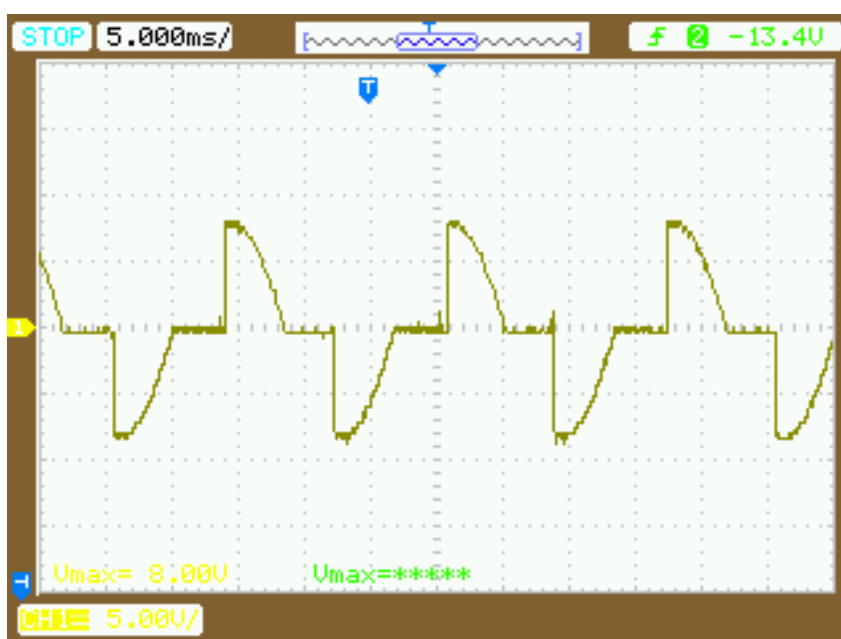
Figura 26 – Saída da onda após dimerização – 50% de potência
