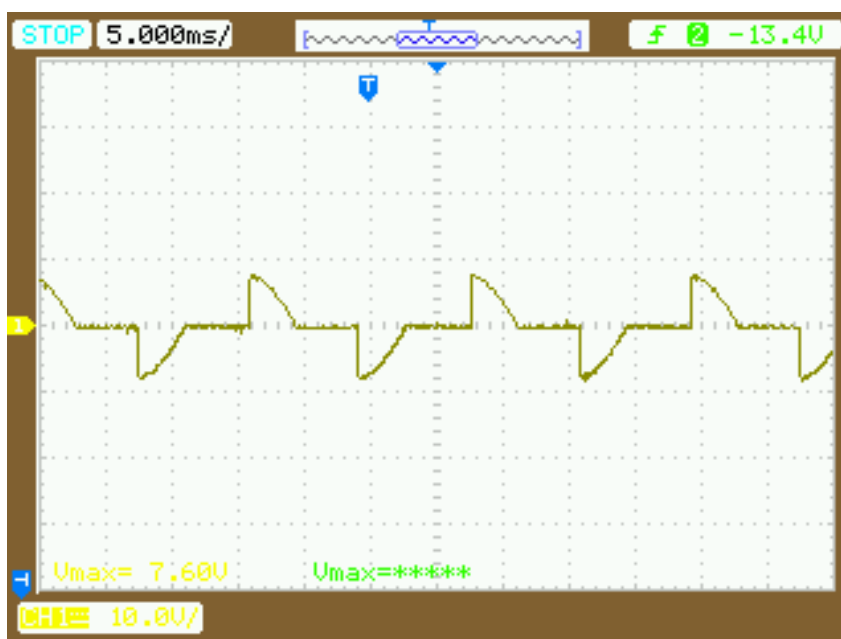
Figura 25 – Saída da onda após dimerização – 25% de potência
