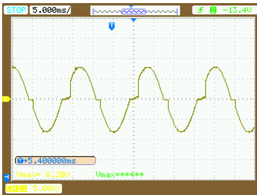
Figura 27 – Saída da onda após dimerização – 90% de potência
