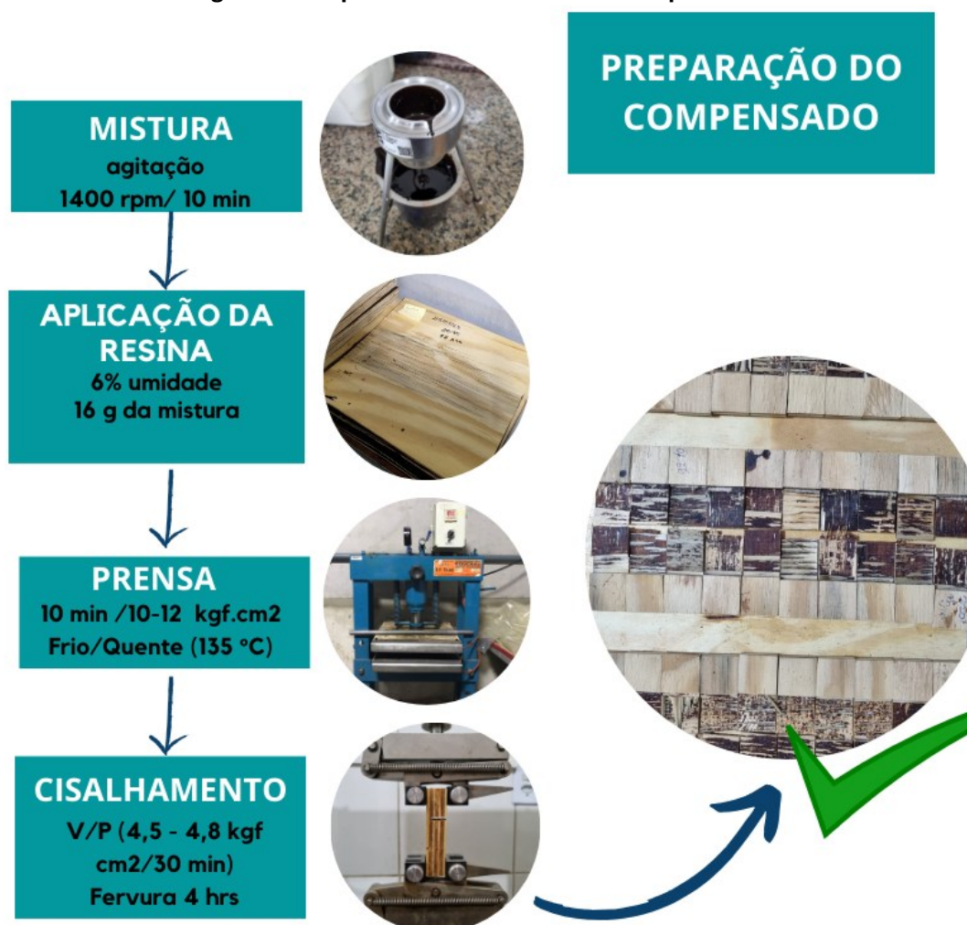
Figura 9 - Preparo e testes físicos do compensado
