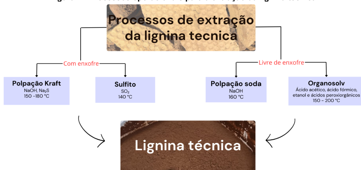
Figura 4 - Processos operacionais para a extração da lignina técnica
