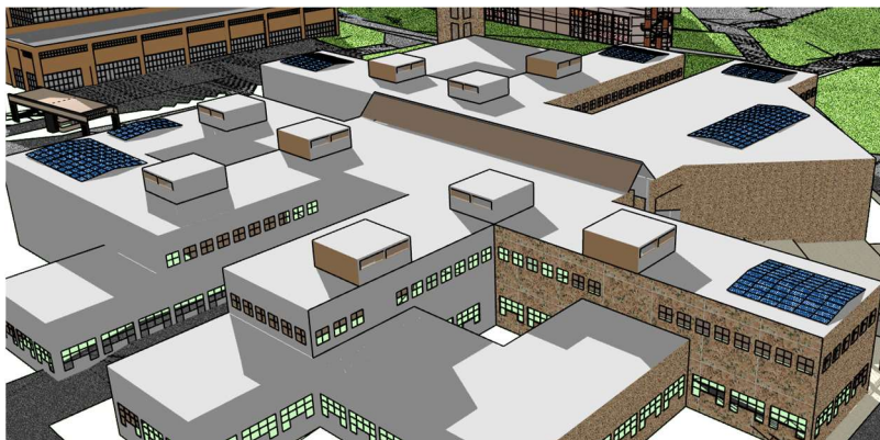
Figura 16 – Simulação sombreamento telhado principal – Solstício as 09:00
