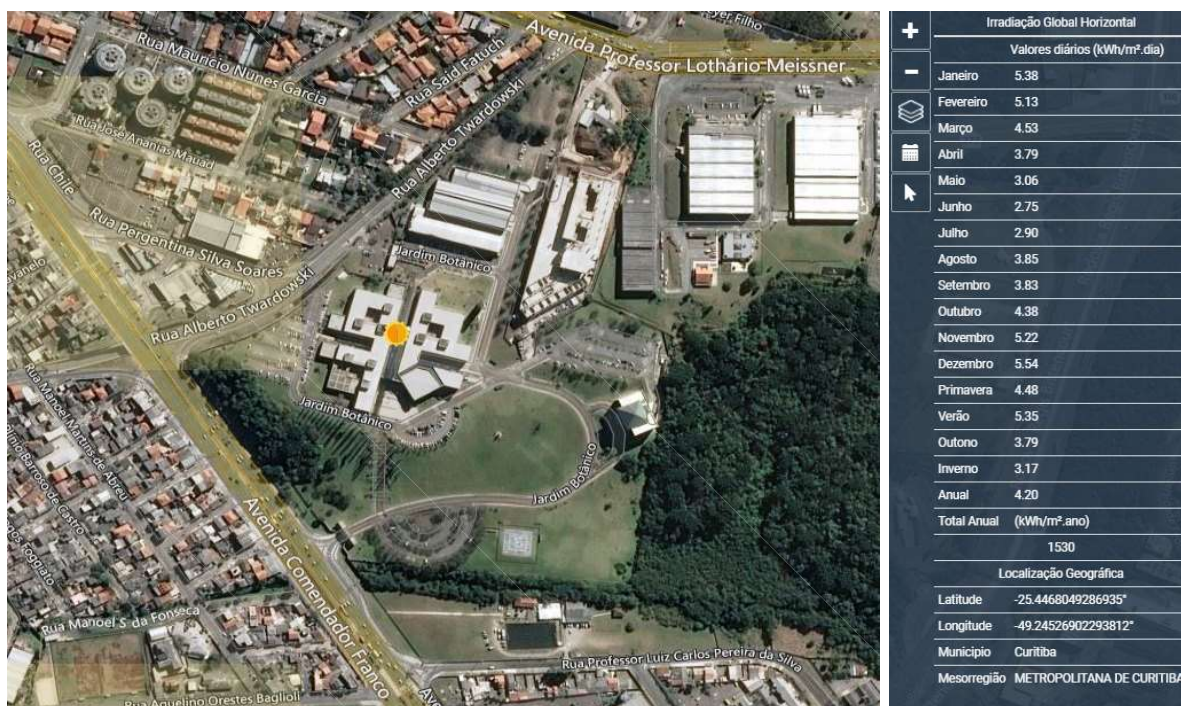
Figura 25 – Irradiação Global Horizontal no ponto do projeto.
