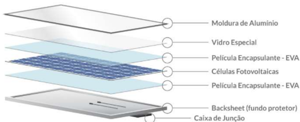
Figura 10 – Estrutura de um módulo fotovoltaico.
