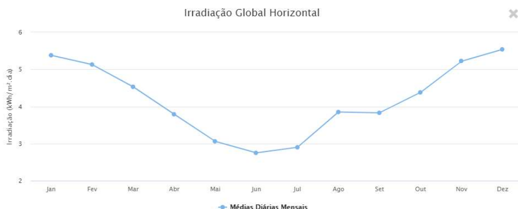
Figura 26 – Irradiação Global Horizontal ao longo de um ano típico.
