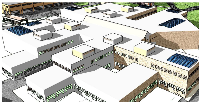
Figura 17 – Simulação sombreamento telhado principal – Solstício as 16:00
