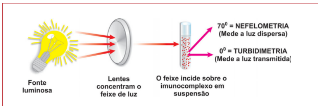
Figura 1 – Diferença entre a análise da nefelometria e turbidimetria
