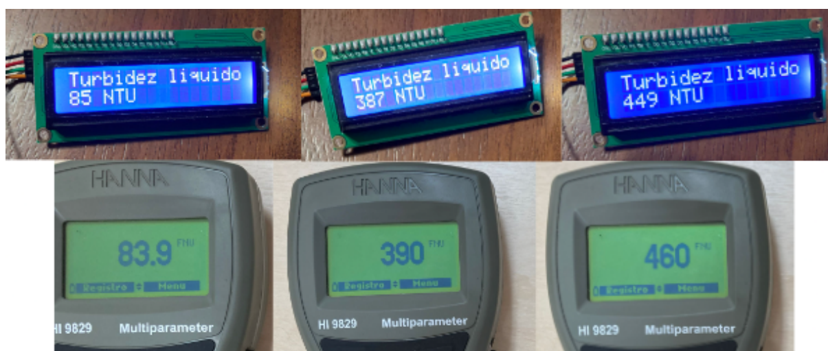
Figura 20 – Diferença entre as medições dos dois turbidímetros
