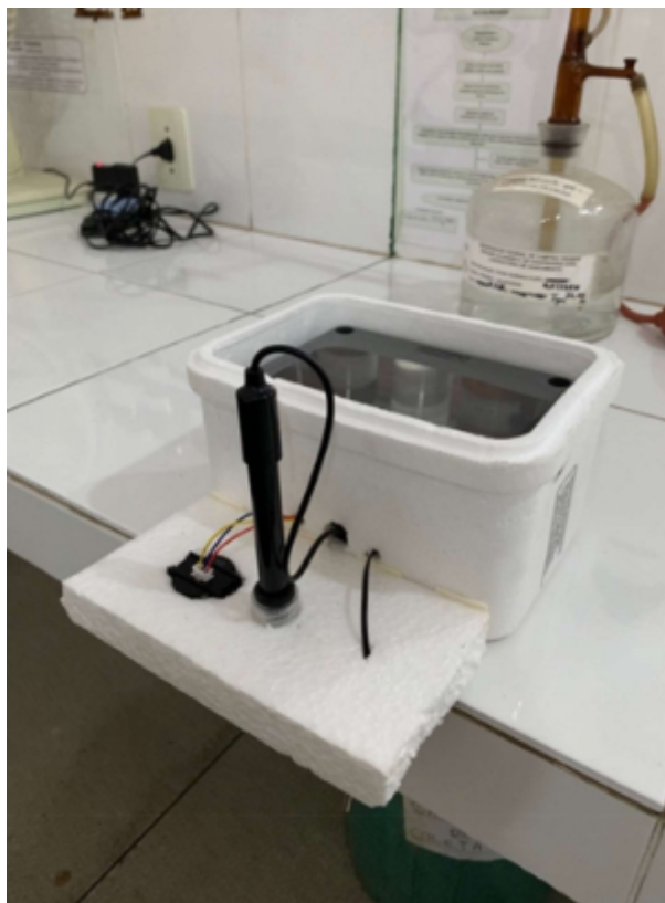
Figura 6 – Protótipo do sistema de monitoramento da qualidade da água desenvolvido por Targino et al. (2021)
