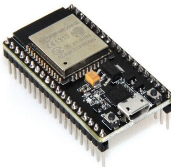
Figura 15 – Foto ilustrativa do microcontrolador Esp 32 utilizado no trabalho
