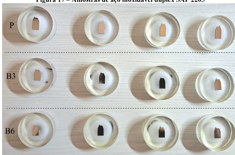
Figura 17 – Amostras de aço inoxidável duplex SAF 2205
