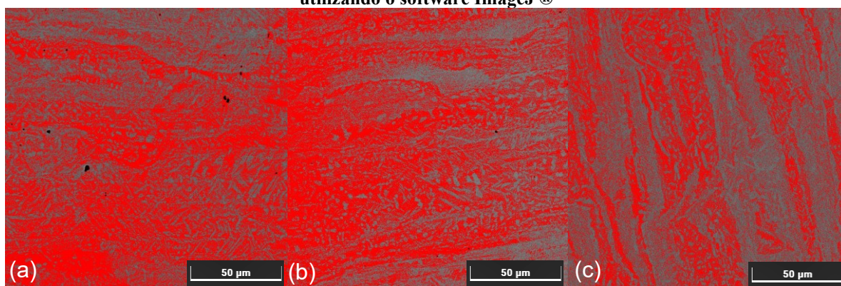
Figura 36 - Determinação da fração volumétrica da fase \delta para as amostras P1 (a), P3 (b) e P4 (c) utilizando o software ImageJ ®
