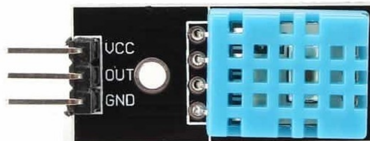
Figura 8 – Sensor de temperatura e umidade - módulo DHT11
