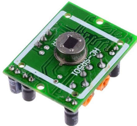
Figura 6 – Sensor de presença - módulo PIR DYP-ME003
