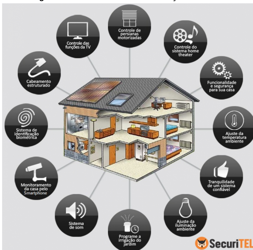
Figura 1 – Periféricos de uma automação residencial
