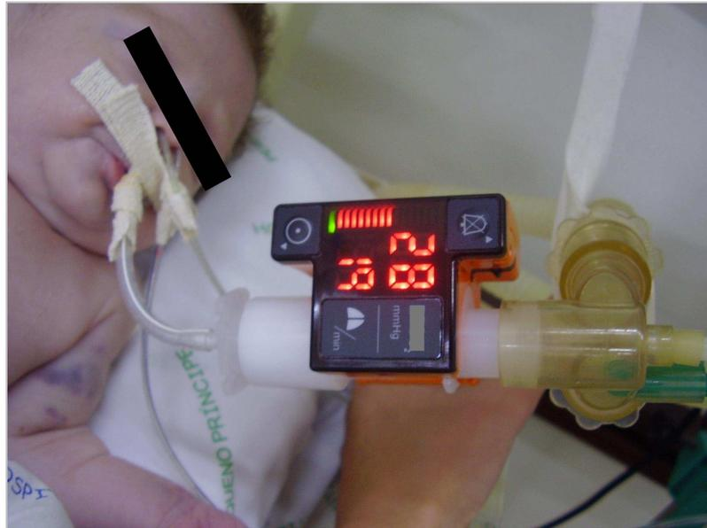
**Figura 9 - Arranjo do equipamento de Capnometria adaptado entre o tubo endotraqueal e o circuito do ventilador mecânico. O valor 28 refere-se à concentração de dióxido de carbono no ar exalado e o valor 19 a frequência respiratória do paciente.**
