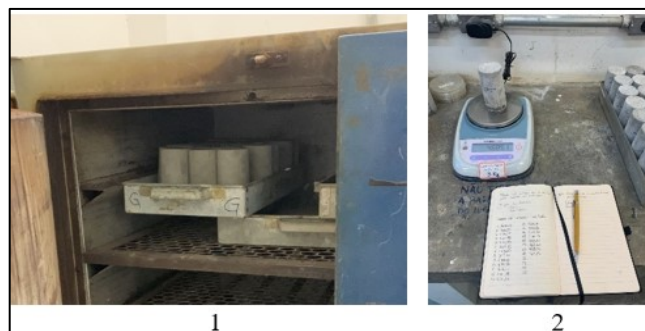
Figura 18 – Processo experimental: Retiradas as amostras do processo de cura foram colocadas para secagem na estufa por 24 h à 100°C (1), as amostras secas foram pesadas para a definição da massa aparente seca
