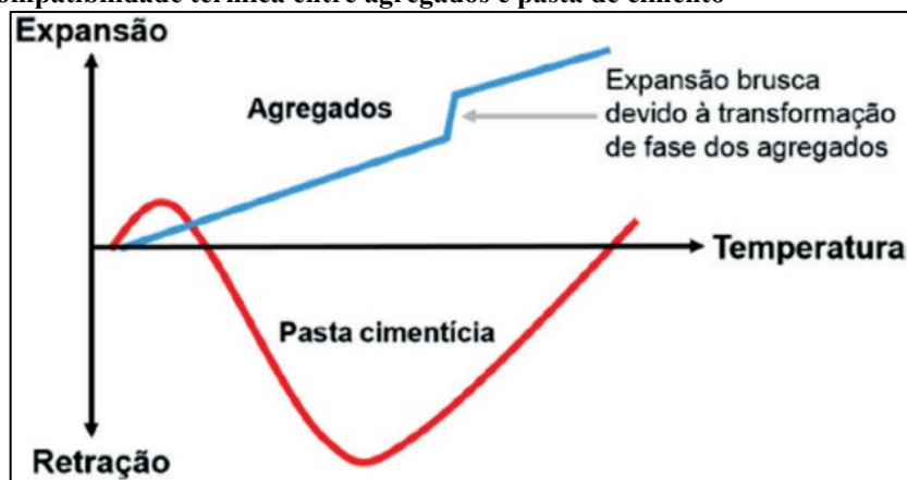
Figura 14 – Incompatibilidade térmica entre agregados e pasta de cimento
