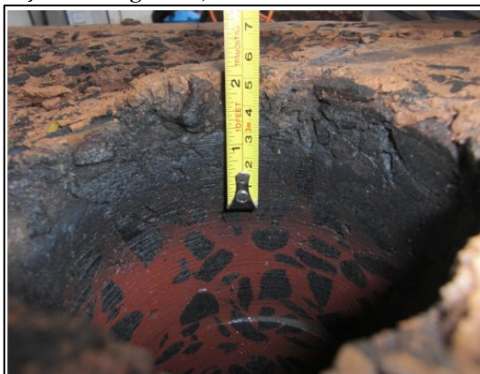
Figura 12 – Mudança de coloração da magnetita, transformada em hematita pela ação do calor aos 570^\circ\text{C}
