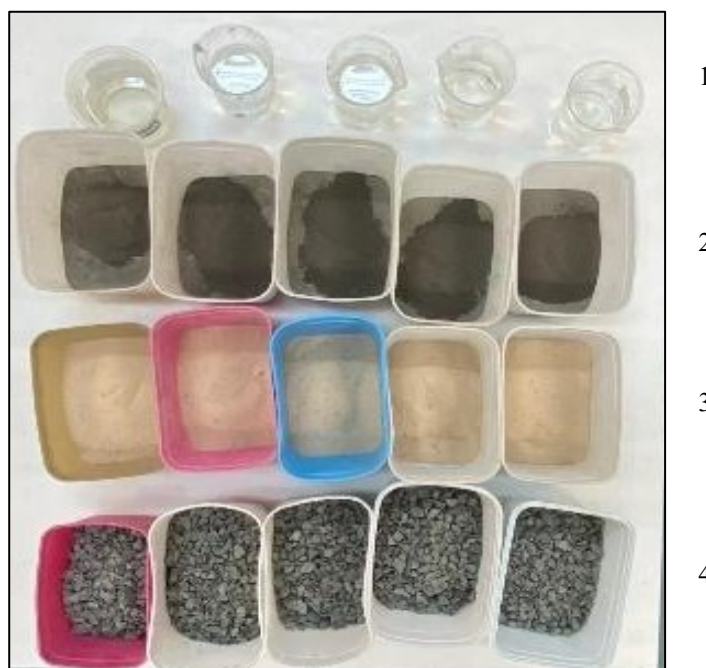
Figura 16 – Materiais utilizados: Água (1), cimento (2), areia (3) e brita (4).
