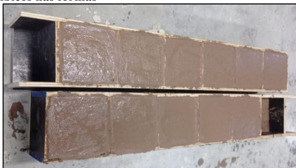
Figura 22 – Corpos de prova cúbicos nas formas
