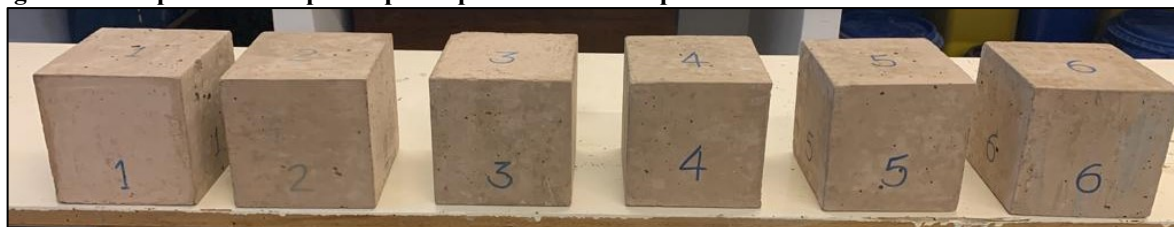
Figura 23 – Aspecto dos corpos de prova pré-ensaio de temperatura
