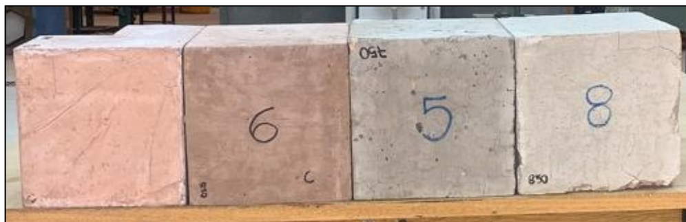
Figura 25 – Efeito do calor na pigmentação dos corpos de prova cúbicos
