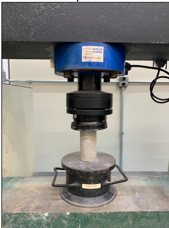
Figura 21 – Ensaio de compressão axial nos CP de concreto
