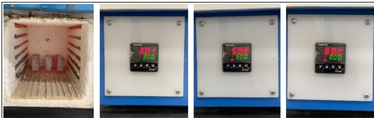
Figura 19 – Disposição dos corpos de prova no forno mufla e indicativo das temperaturas de 300°C, 500°C e 800°C
