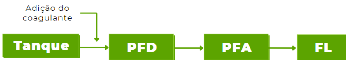
Figura 6- Fluxograma de operação do sistema FiME.
