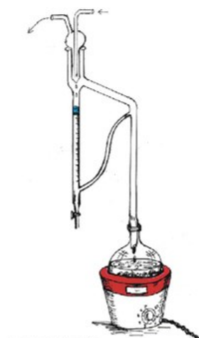
Figura 5 – Esquema de Hidrodestilação com Aparelho de Clevenger.
