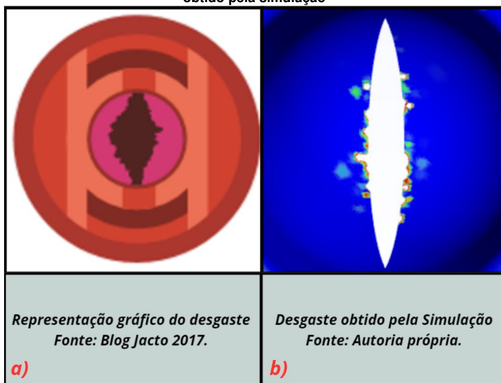
Figura 49 - Comparativo entre representação gráfica do desgaste do fabricante com resultado obtido pela simulação
