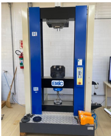
Figura 8 - Máquina universal de ensaios - EMIC DL3000N.
