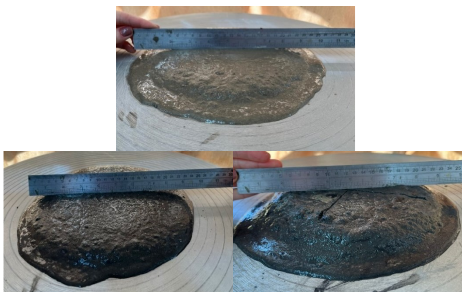
Figura 6 – Medição do espalhamento das argamassas.
