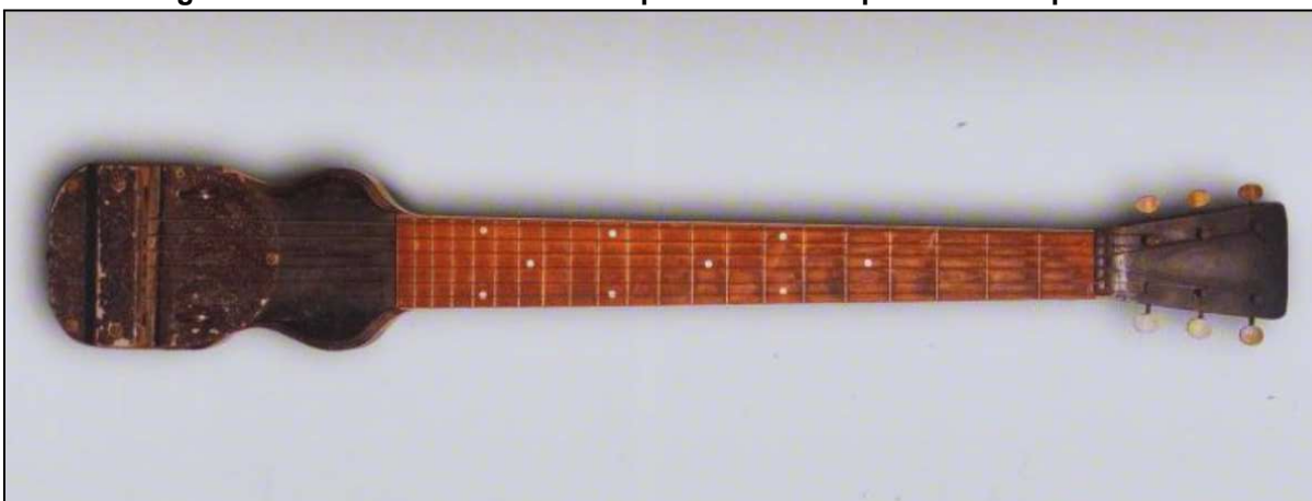
Figura 11 - Instrumento construído por Leo Fender para testar captadores
