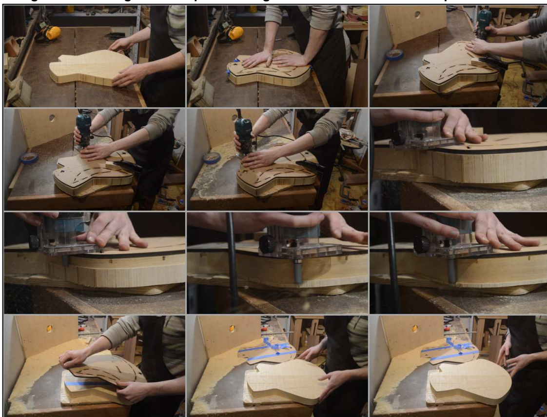
Figura 29 - Usinagem do corpo de uma guitarra utilizando molde e tupia laminadora
