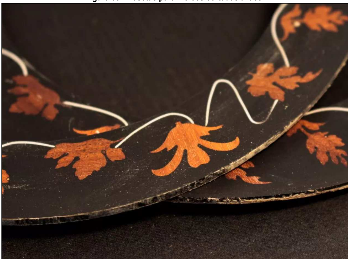
Figura 35 - Rosetas para violões cortadas a laser
