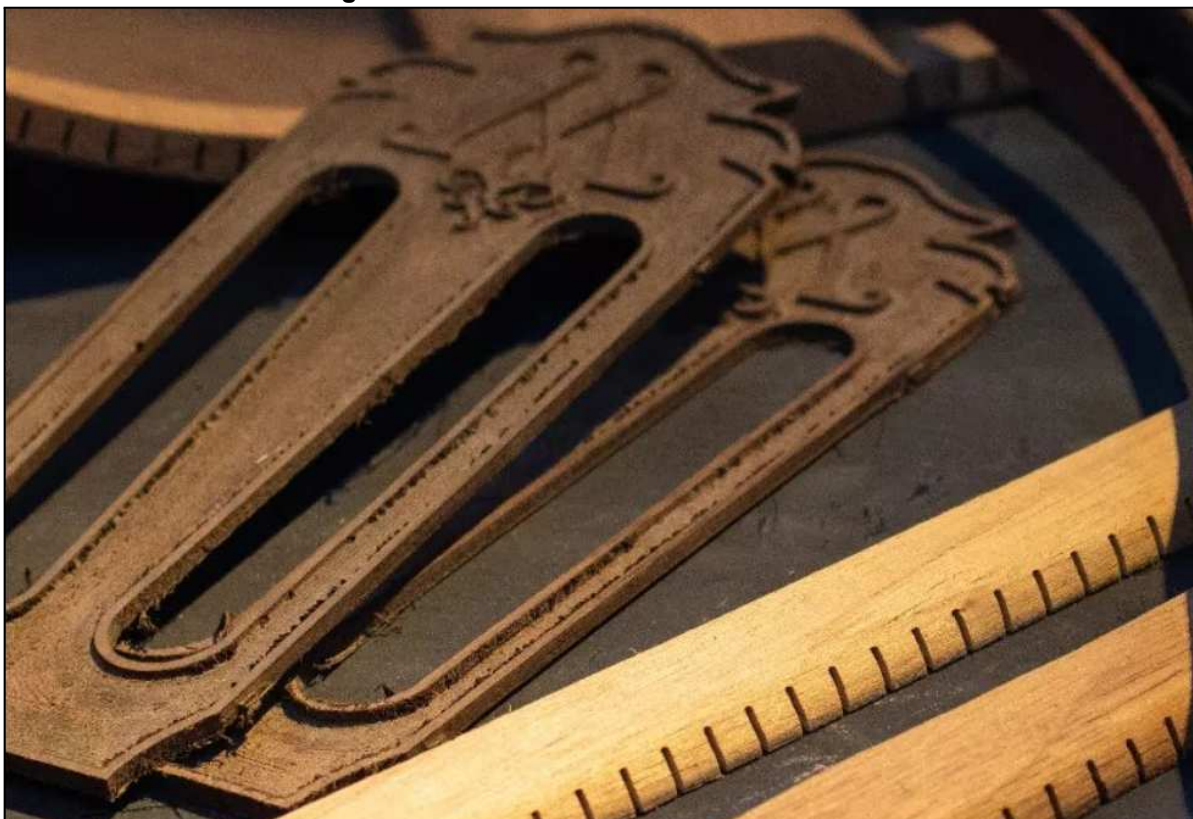
Figura 32 - Palas de violão usinadas em CNC
