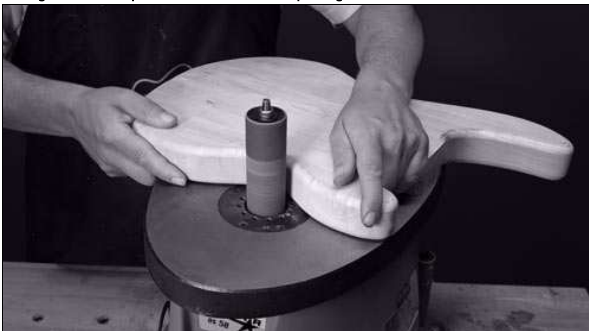
Figura 42 - Exemplo de desbaste de um corpo de guitarra usando o rolo de lixa vertical
