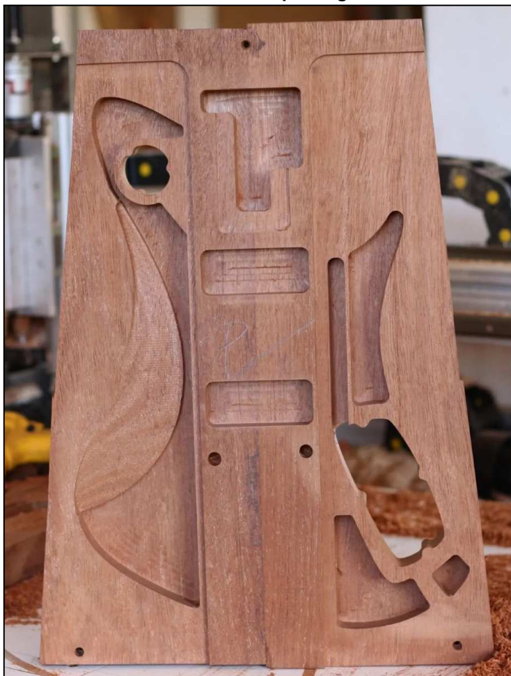
Figura 31 - Cavidades internas do corpo da guitarra usinadas em CNC
