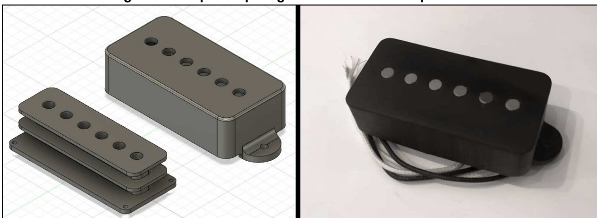
Figura 41 - Captador para guitarra criado com impressão 3D
