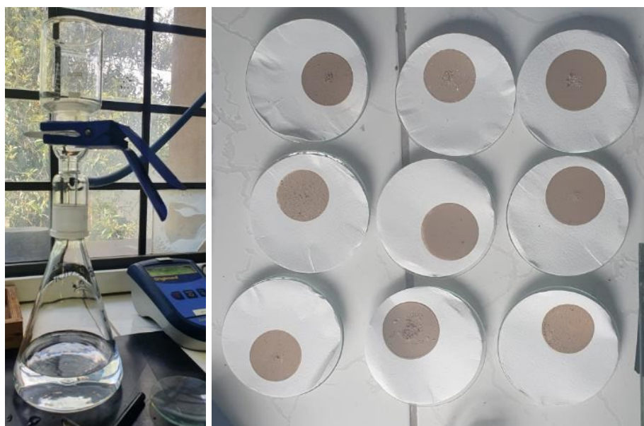
Figura 25: Filtros após filtração e secagem
