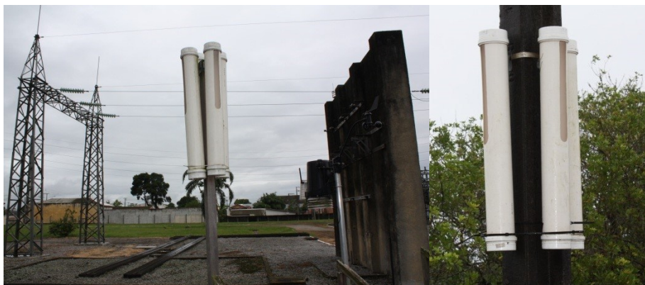
Figura 23: Exemplo de estruturas de coleta de poluentes em campo, pelo método do CDDP.
