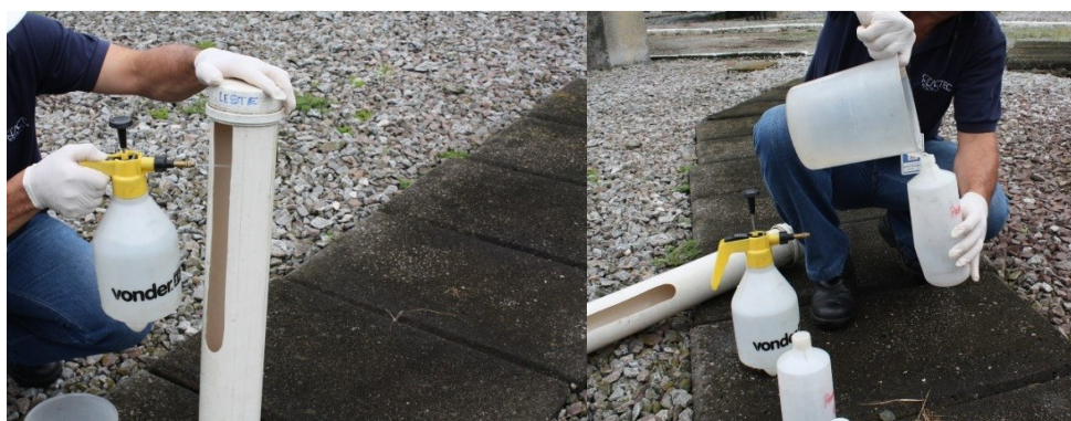
Figura 24: Processo de coleta de amostras de poluentes em campo, a partir de CDDPs.
