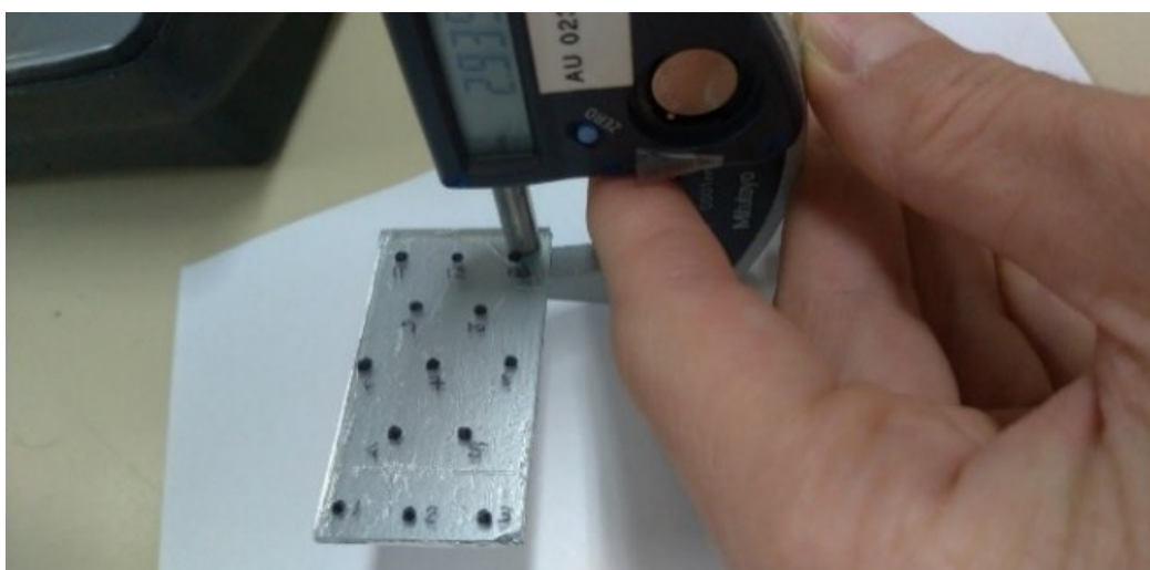
Figura 69: Processo de medição da lâmina de alumínio, com micrómetro.
