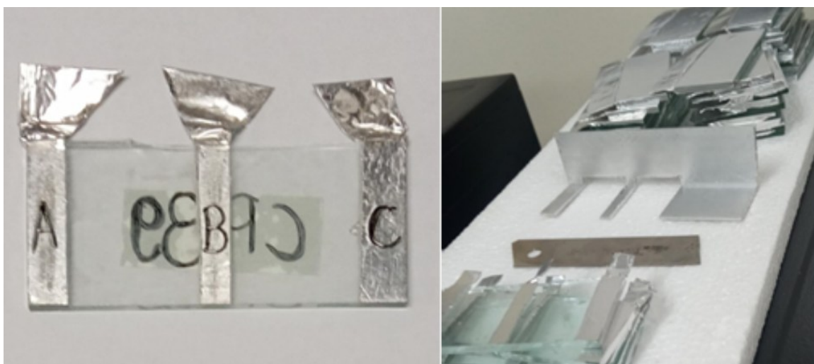
(a) destaque para o substrato já com os eletrodos; (b) Manufatura dos substratos.
