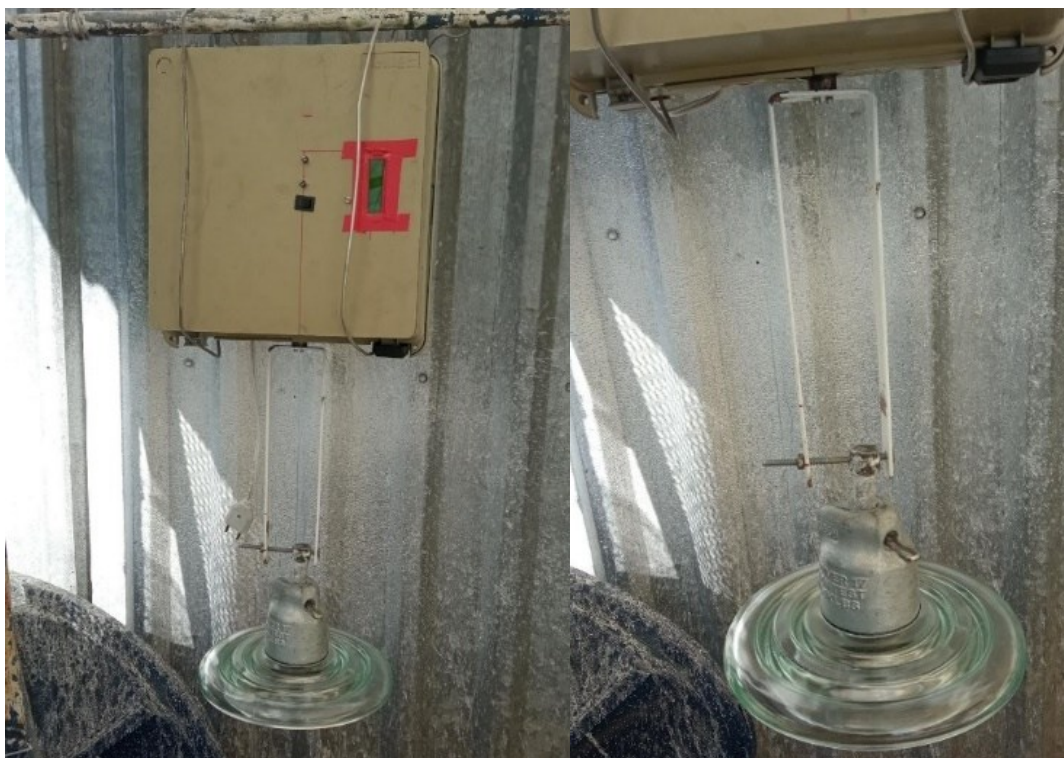
Figura 39: Equipamento de controle de exposição à aplicação de poluição artificial.
