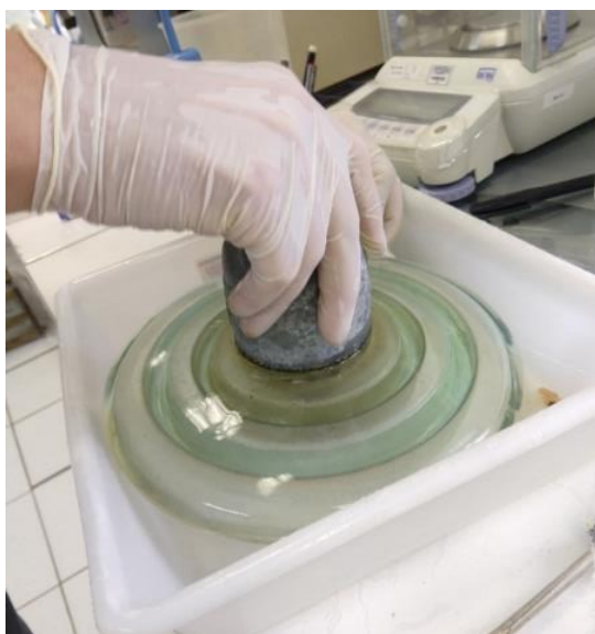
Figura 21: Coleta de poluentes, face superior do isolador.
