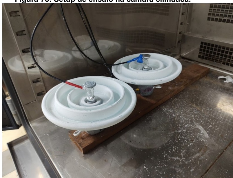
Figura 75: Setup de ensaio na câmara climática.
