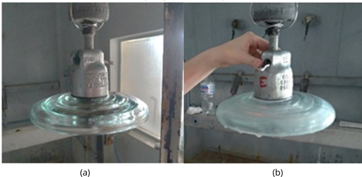
Figura 37: Isolador padrão (disco de vidro modelo U120) antes (a) e após (b) a deposição da solução 1 pelo processo de aspersão.
