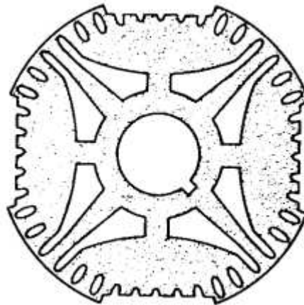
Figura 16 - Motor síncrono com polos salientes e enrolamentos de indução
