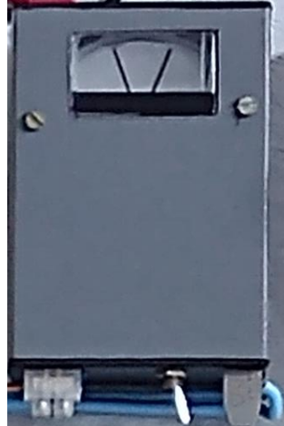
Fotografia 6- Estroboscópio utilizado para verificar sincronismo
