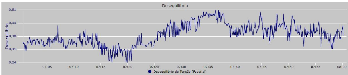
Figura 37 – Desequilíbrio de tensão durante o período de 07h00 e 08h00 com o sistema fotovoltaico (a) ligado e (b) desligado
