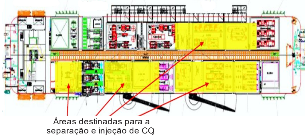
Figura 6 – Vista superior de uma unidade de produção offshore com indicação das áreas ocupadas para o processamento e injeção de \text{CO}_2 supercrítico.
