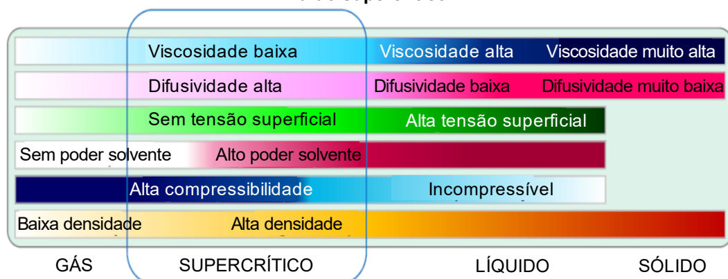
Figura 8 – Esquemático do comportamento híbrido das propriedades termo-físicas de um fluido supercrítico.
