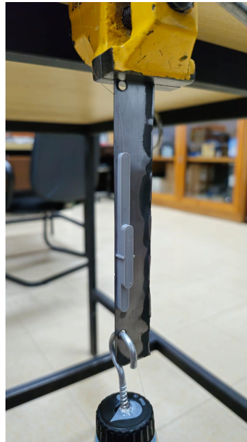
Figura 10 – Método para calibração em deformação em laboratório
