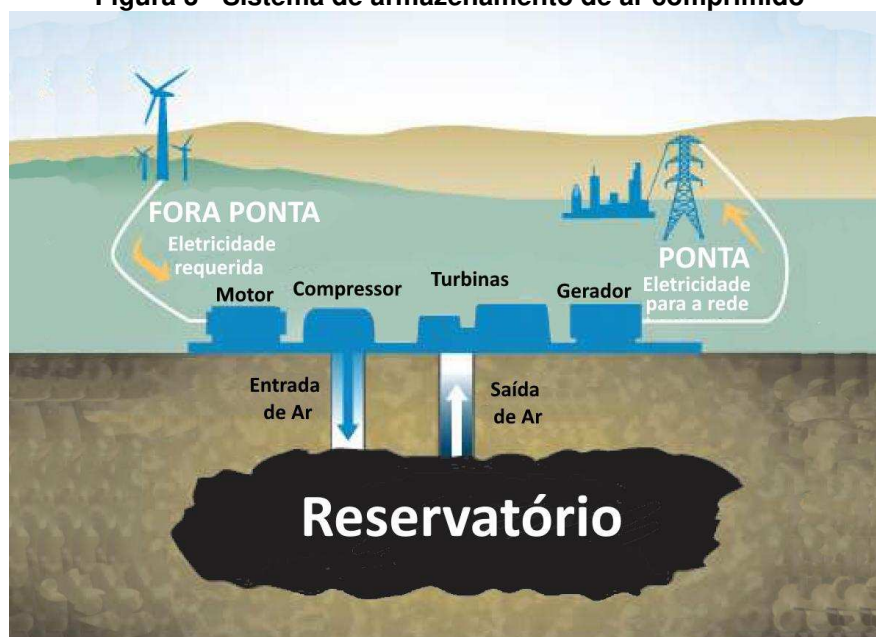
Figura 3 - Sistema de armazenamento de ar comprimido
